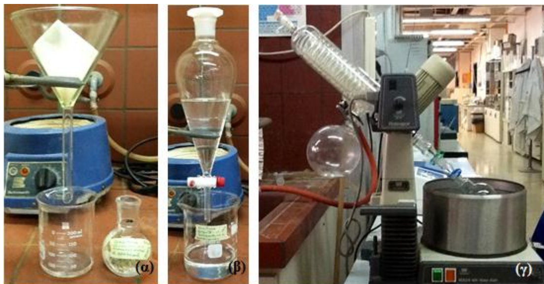
Σχήμα 1.8. (α) Διήθηση του μίγματος της αντίδρασης για απομάκρυνση του ενζύμου και των μοριακών κοσκίων, (β) Διαχωρισμός των φάσεων κατά την εκχύλιση, (γ) Εξάτμιση της οργανικής φάσης σε περιστροφικό εξατμιστήρα
