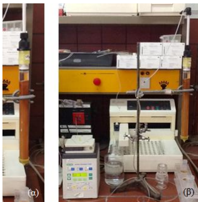
Σχήμα 4.16. (α) Στήλη ιοντο-ανταλλαγής, (β) Σύστημα απομόνωσης όξινων ξυλοολιγοσακχαριτών
