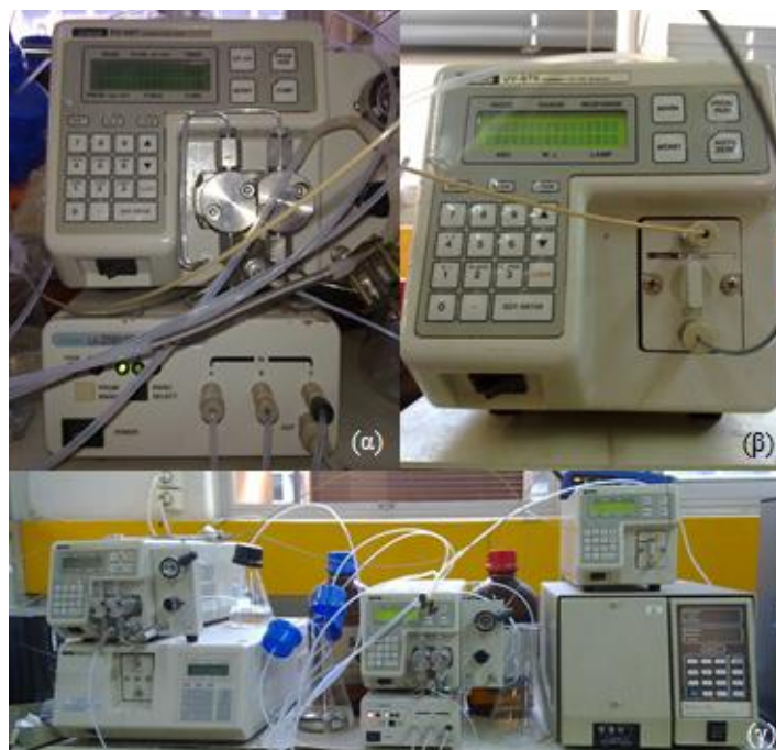
Σχήμα 4.14. (α) Αντλία υψηλής πίεσεως PU 987 Jasco (Ιαπωνία) και mixer, (β) Φωτομετρικός ανιχνευτής UV 975, (γ) Σύστημα γρήρης χρωματογραφίας υψηλής απόδοσης (HPLC)
