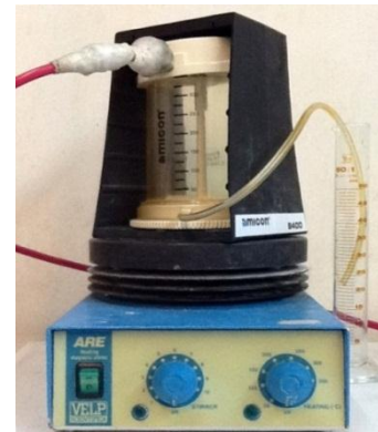
Σχήμα 4.1. Διάταξη υπερδιήθησης Stirred Cell Model 8400 (Amicon, Millipore, Η.Π.Α.)
