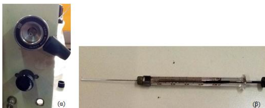
Σχήμα 4.15. (α) Βαλβίδα εισαγωγής δείγματος (Rheodyne), (β) Σύριγγα εισαγωγής δείγματος (Hamilton)
