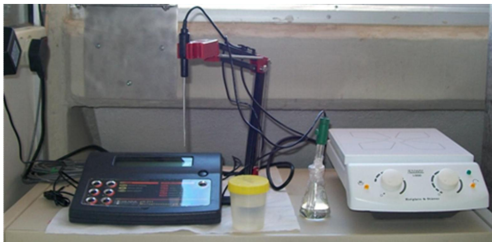
Σχήμα 5.14 Ειδική διάταξη για την μέτρηση και ρύθμιση του pH του ηλεκτρολυτικού διαλύματος
