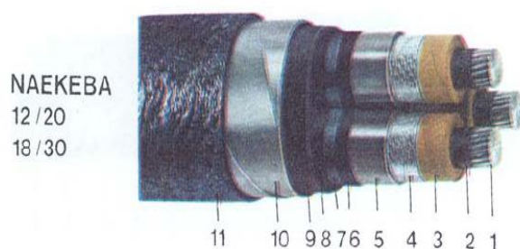
Σχήμα 5.15 Καλώδιο MT ακτινικού πεδίου NAEKEBA 12/20...18/30kV : (1) αγωγός,(2) εξομαλυντικό ημιαγώγιμο στρώμα, (3) μόνωση, (4) ταινίες από αλουμίνιο, (5) μόλυβδος, (6),(7),(8),(9) προστατευτικά στρώματα, (10) ταινία χαλύβδινη, (11) προστατευτικό στρώμα από εμποτισμένες ίνες.
