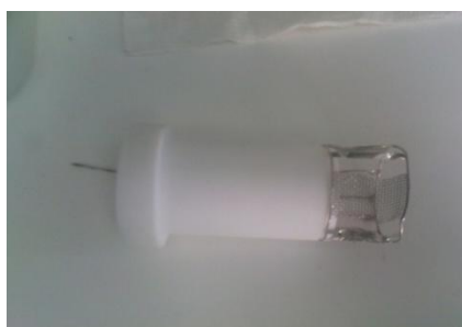
Σχήμα 5.6 Βοηθητικό ηλεκτρόδιο και κυλινδρική κατασκευή από τεφλόν
