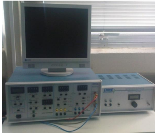
Σχήμα 5.2 Υπολογιστής χειρισμού ηλεκτροχημικού κελίου, διποτενσιοστάτης και ρυθμιστής στροφών ρότορα.
