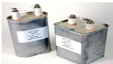
Σχήμα 5.14 Πυκνωτές ελαίου 2μF και 25μF για φιλτράρισμα της dc συνιστώσας
