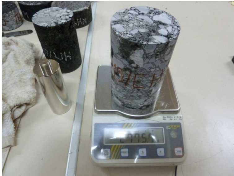
Σχήμα 4.8. Ζύγιση δοκιμίου μετά το σκούπισμα της επιφάνειάς του
