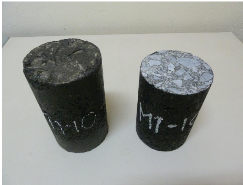
Σχήμα 5.2. Δοκίμιο διαμέτρου 100mm και ύψους 170mm και ίδιο δοκίμιο μετά την κοπή
