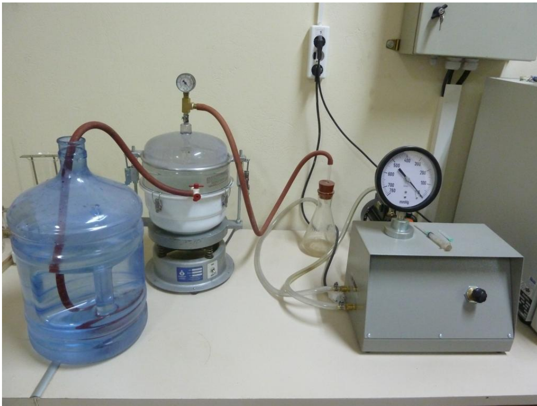
Σχήμα 4.5. Δοκιμή προσδιορισμού μέγιστης πυκνότητας ασφαλτομίγματος
