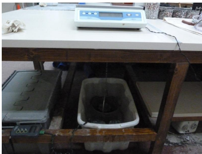
Σχήμα 4.7. Δοκιμή προσδιορισμού της φαινόμενης πυκνότητας – υγρή μέθοδος
