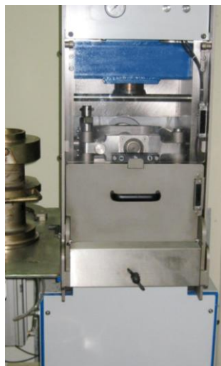
Σχήμα 3.8. Μέτρηση της γωνίας στη γυροσκοπική συσκευή του Ε.Μ.Π.
