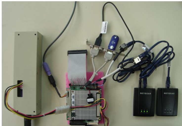
Σχήμα 3.19 Αρχική υλοποίηση του ηλεκτρικού σχεδίου.
