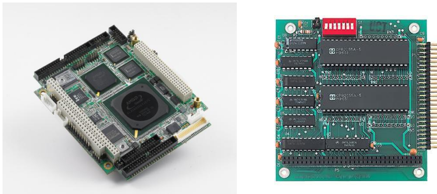
Σχήμα 3.15 Αριστερά: Η κεντρική μονάδα επεξεργασίας PCM-4153 της Advantech. Δεξιά: Κάρτα ψηφιακών εισόδων εξόδων PC104-DIO48 της Measurement Computing.
