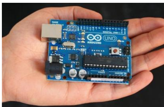
Σχήμα 5.9 Αριστερά: η πλακέτα Arduino. Δεξιά: Τεχνικά χαρακτηριστικά της πλακέτας.
