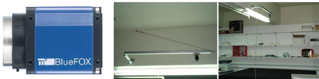
Σχήμα 4.1 Αριστερά: Η κάμερα mvBlueFOX-124G. Δεξιά: Φαίνεται ο τρόπος στήριξης της πάνω από τον χώρο εργασίας.
