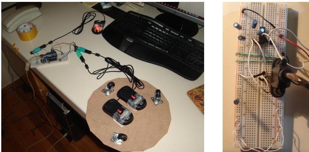
Σχήμα 5.12 Αριστερά: Πείραμα λήψης δεδομένων από 3 οπτικούς αισθητήρες. Δεξιά: δοκιμή κυκλώματος σειριακής επικοινωνίας RS-232.
