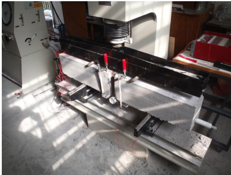
Σχήμα 3-13: Η δοκός-δοκίμιο στη μηχανή κάμψης
