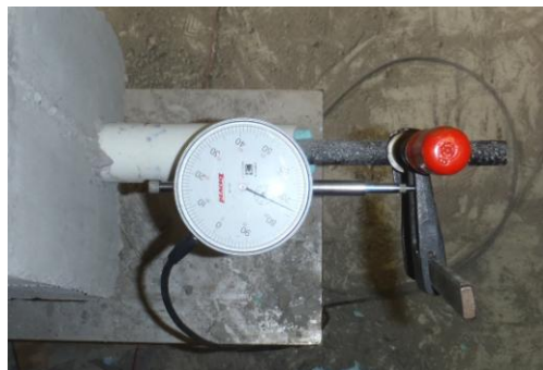
Σχήμα 3-12: Τα βελόμετρα τοποθετημένα στο δοκίμιο
