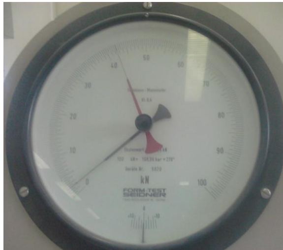
Σχήμα 3-8: Σύστημα ανάγνωσης επιβαλλόμενου φορτίου
