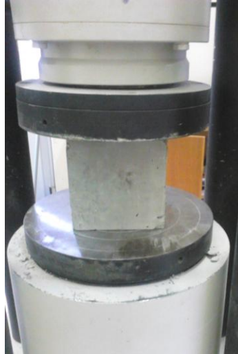
Σχήμα 3-6: Δοκιμή θλίψης κυβικού δοκιμίου
