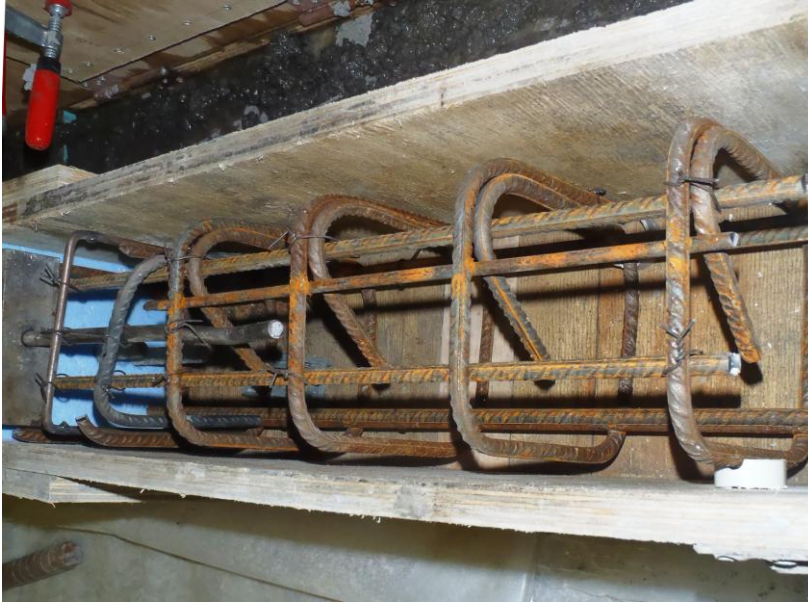
Σχήμα 3-2: Οι συνδετήρες του δοκιμίου
