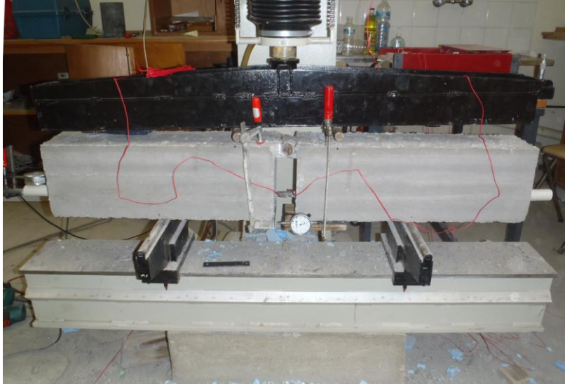
Σχήμα 3-7: Το δοκίμιο στη μηχανή κάμψης
