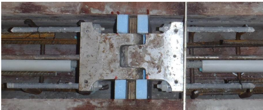
Σχήμα 3-3: Η μεταλλική άρθρωση της δοκού-δοκιμίου
