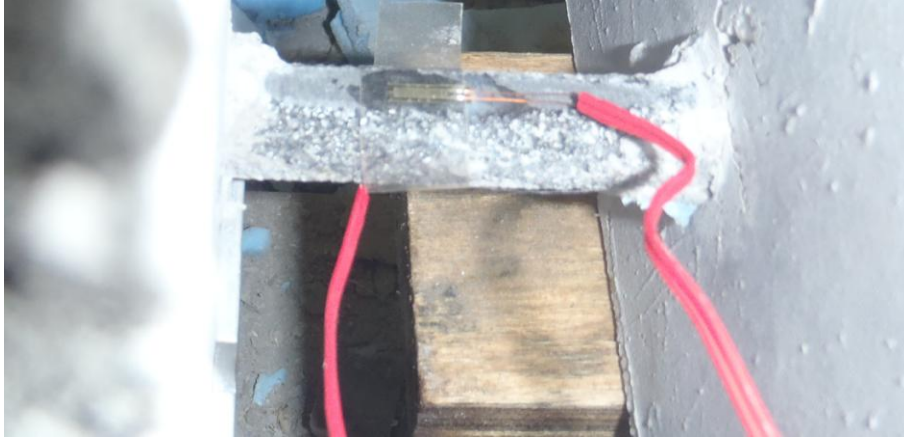
Σχήμα 3-9: Τα ηλεκτρομηκυσιομέτρα επικολλημένα στη ράβδο
