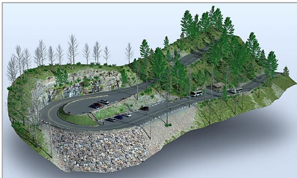
Εικόνα 1.3: Τρισδιάστατο προσομοίωμα ενός ανακάμπτοντα ελιγμού, όπως αυτός ενσωματώνεται στον περιβάλλοντα χώρο. (Πηγή: Armstrong A., Gilson K.: «Using Design Visualization Technologies to Improve the Highway Design Process», Transportation Research Board of the National Academies, Washington D.C. 2008, FIGURE 9)
