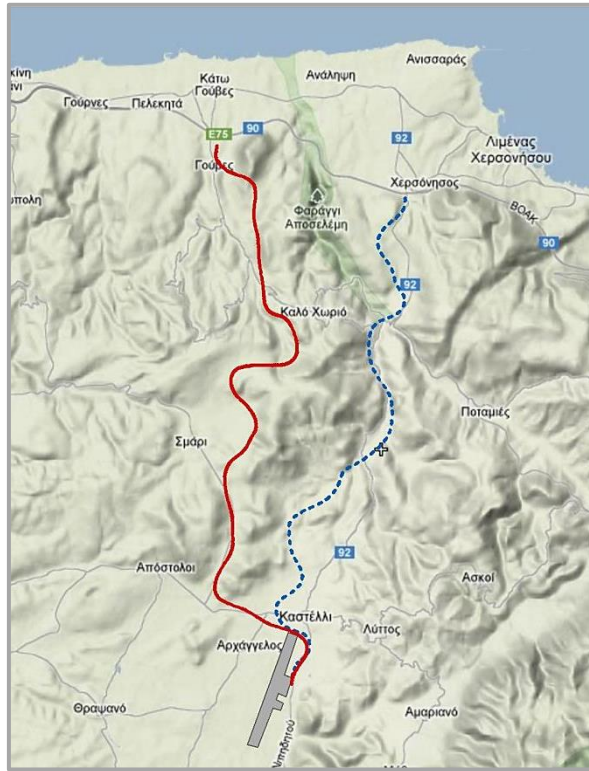
Εικόνα 6.6: 2 η δοκιμαστική χάραξη. Με διακεκομμένη γραμμή σημειώνεται η προηγούμενη (1 η ) δοκιμαστική χάραξη. (Πηγή χάρτη: Χάρτες Google – http://maps.google.com )
