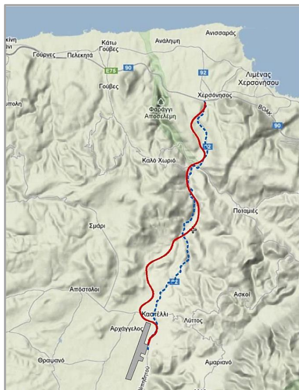
Εικόνα 6.5: 1 η δοκιμαστική χάραξη. Με διακεκομμένη γραμμή σημειώνεται η υπάρχουσα χάραξη. (Πηγή χάρτη: Χάρτες Google – http://maps.google.com )
