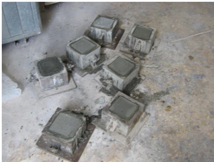
Φωτογραφία 16. Τα δοκίμια που προετοιμάστηκαν για τη δοκιμή της θλιπτικής αντοχής του σκυροδέματος
