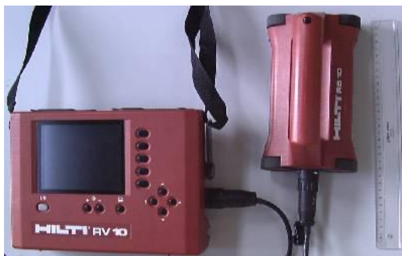
Φωτογραφία 6. Όργανο Ferrosan RV10 (αριστερά) και ανιχνευτής RS10 (δεξιά) (μήκος χάρακα: 30cm)
