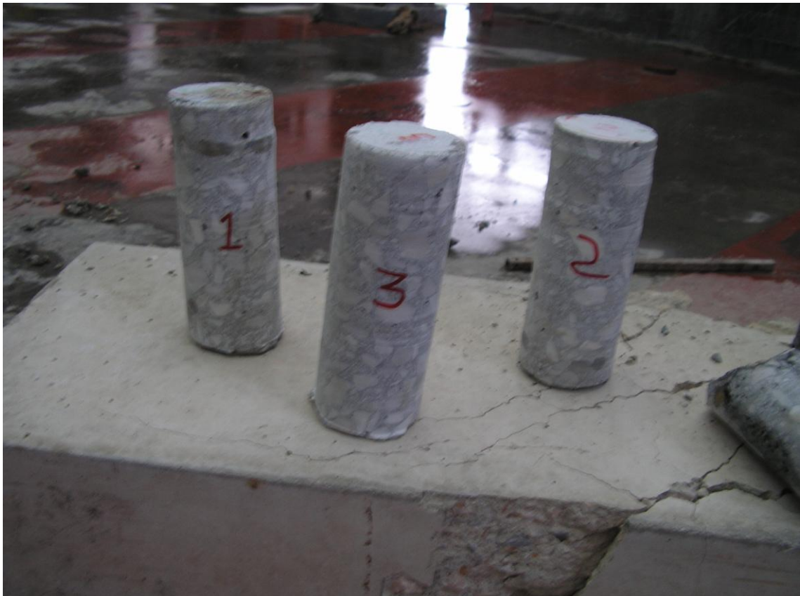
Φωτογραφία 3. Οι πυρήνες για τη δοκιμή της θλιπτικής αντοχής του σκυροδέματος
