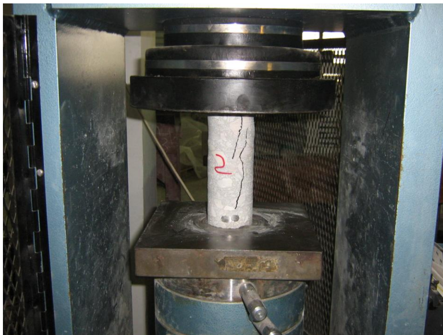
Φωτογραφία 5. Δοκιμή θλιπτικής αντοχής του σκυροδέματος
