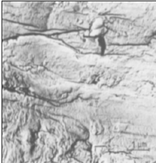
Εικόνα 7. Έναρξη φθοράς εξέλκωσης (scuffing) στην επιφάνεια οδοντωτού τροχού, [6]
