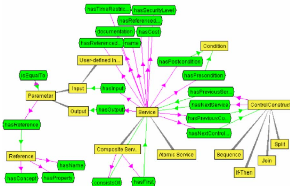
Σχήμα II. 9 Οντολογία Process του προγράμματος OntoGov . Πηγή: ( OntoGov Project, 2004 )
