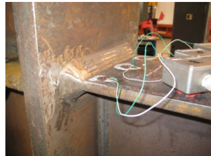
Σχήμα 5.11: Λεπτομέρεια εξωραφών για την περίπτωση δοκών διατομής IPE500
