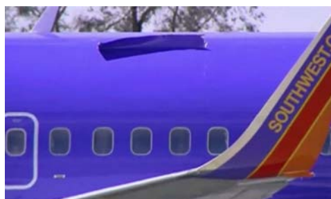
Σχήμα 1.4: Ψαθυρή αστοχία λόγω κόπωσης στην άτρακτο ενός αεροσκάφους [11]
