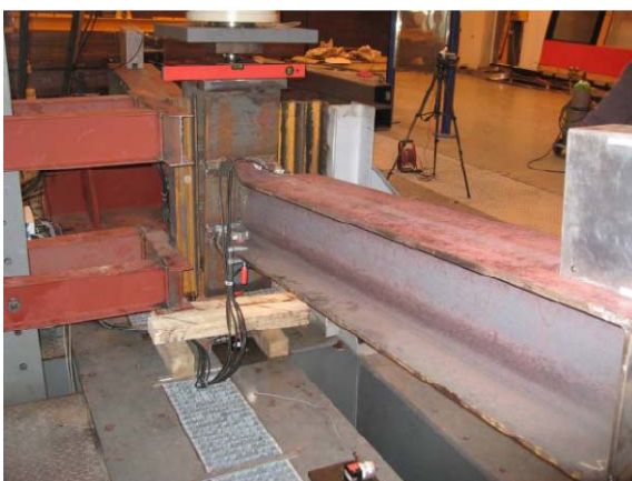
Σχήμα 5.15: Δοκίμιο RT_HEA_355ns μετά το πέρας της μονοτονικής φόρτισης
