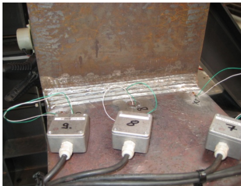
Σχήμα 5.7: Ηλεκτρικά μηχανοσκόπια (αριστερά) και έμβολο (δεξιά)
