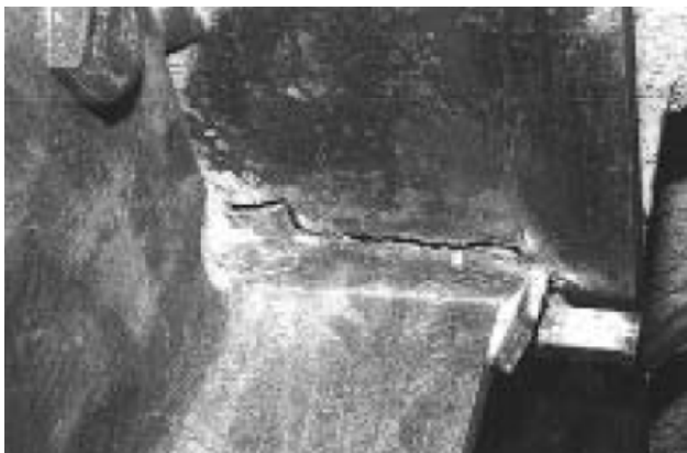
Σχήμα 4.3: Ψαθυρής μορφής αστοχίες από το σεισμό του Northridge σε πλαίσια ροπής στη συγκόλληση δοκού-υποστυλώματος (αριστερά) και στο πέλμα του υποστυλώματος (δεξιά) [13]
