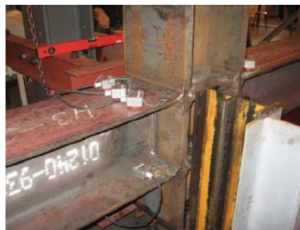
Σχήμα 5.8: Διάταξη ηλεκτρικών μηχανοσυστοιχιών σε κάτοψη (δοκοί HEA300)
