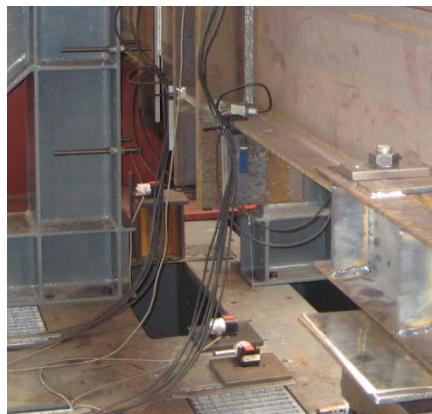
Σχήμα 5.6: Μετρητές μετατόπισης (αριστερά) και κλισίμετρο (δεξιά)
