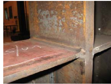
Σχήμα 5.13: Λεπτομέρεια εσωραφών για την περίπτωση των δοκών HEA300
