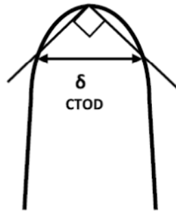
Σχήμα 2.8: Υπολογισμός απόστασης \delta του CTOD
