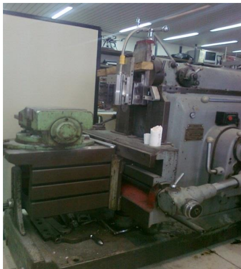
Εικόνα 7. Εργαστηριακή διάταξη κοπής πετρωμάτων
