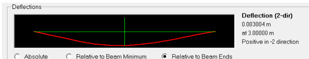
Πίνακας 5.17 Δυσμενέστερη παραμόρφωση δοκού κυλίσεως
