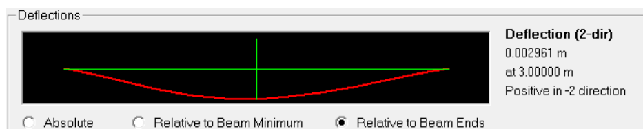
Πίνακας 5.24 Δυσμενέστερη παραμόρφωση δοκού κυλίσεως
