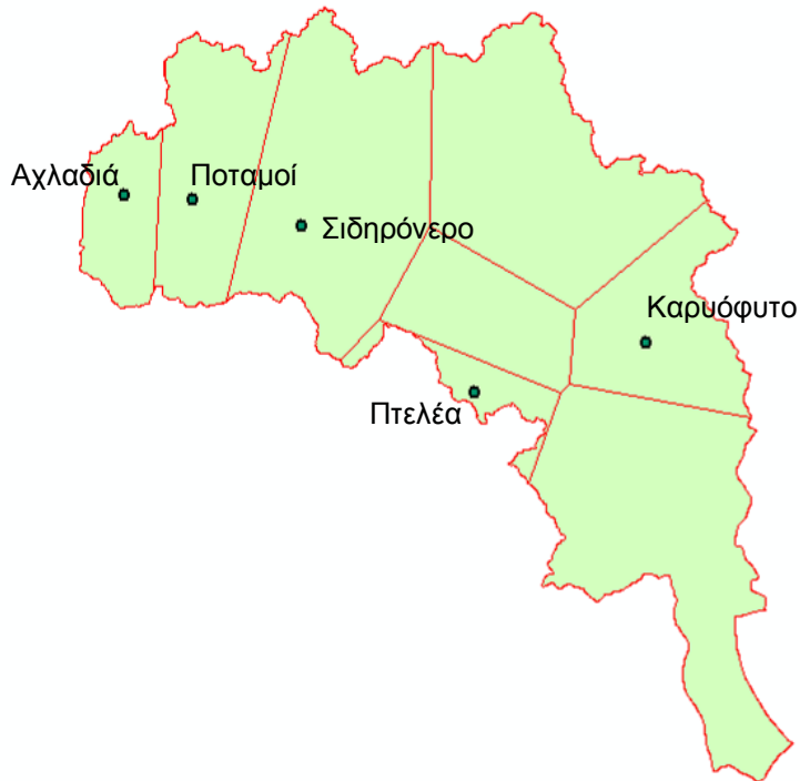
Σχ. 6-8: Τα πολύγωνα Thiessen όπως προέκυψαν από το ArcGIS για τη λεκάνη απορροής του Νέστου
