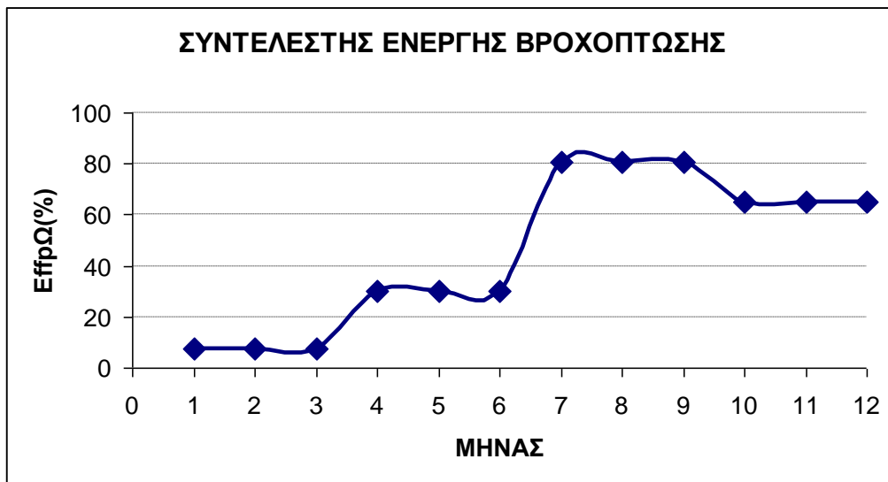
Σχ. 6-16: Αποτελέσματα βαθμονόμησης με χρήση των γενετικών αλγορίθμων για τον συντελεστή ενεργής βροχόπτωσης
