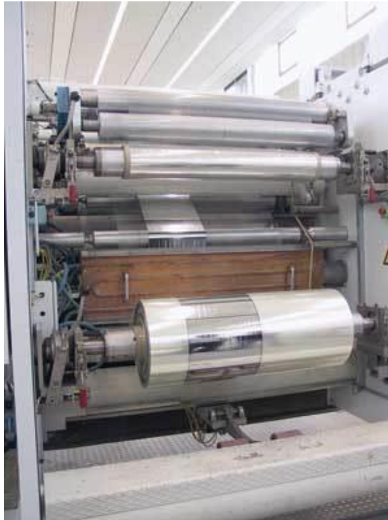
Σχήμα 4.8. Βιομηχανική εγκατάσταση roll-to roll εναπόθεσης SiO x σε φύλλα PET.
