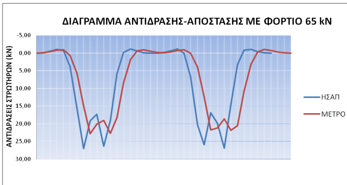
Διάγραμμα 5.10 Αντιδράσεις στρωτήρων με φορτίο 65 \text{ kN} .
