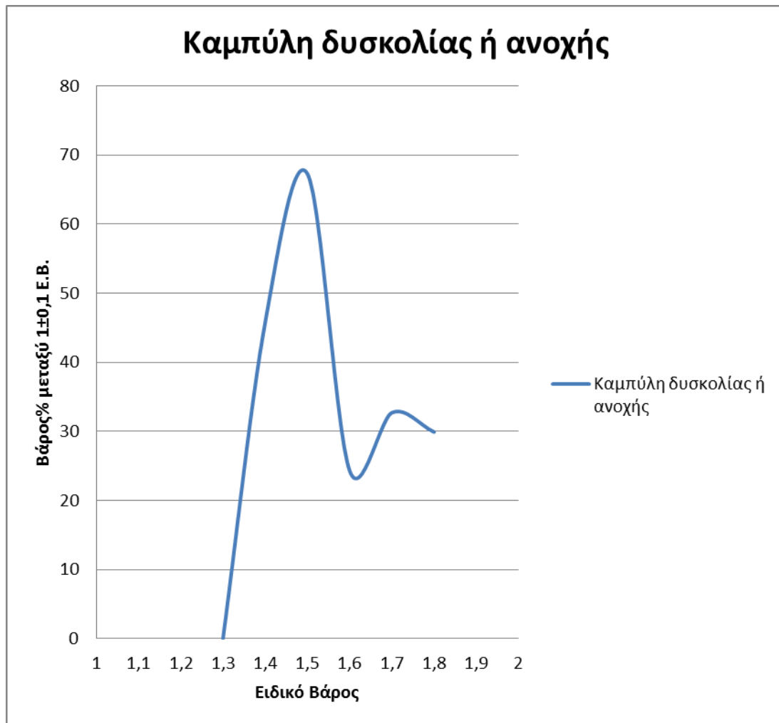
Σχήμα 11. Καμπύλη ανοχής ή δυσκολίας διαχωρισμού για κοκκομετρικό κλάσμα +20mm
