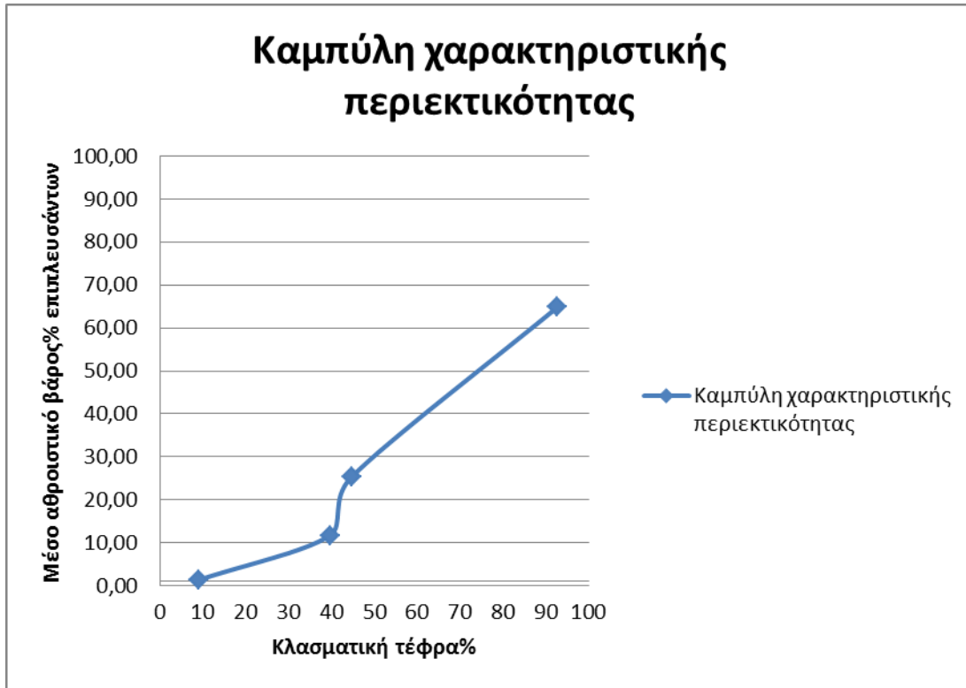
Σχήμα 29. Καμπύλη χαρακτηριστικής περιεκτικότητας για το κοκκομετρικό κλάσμα -2,35mm
