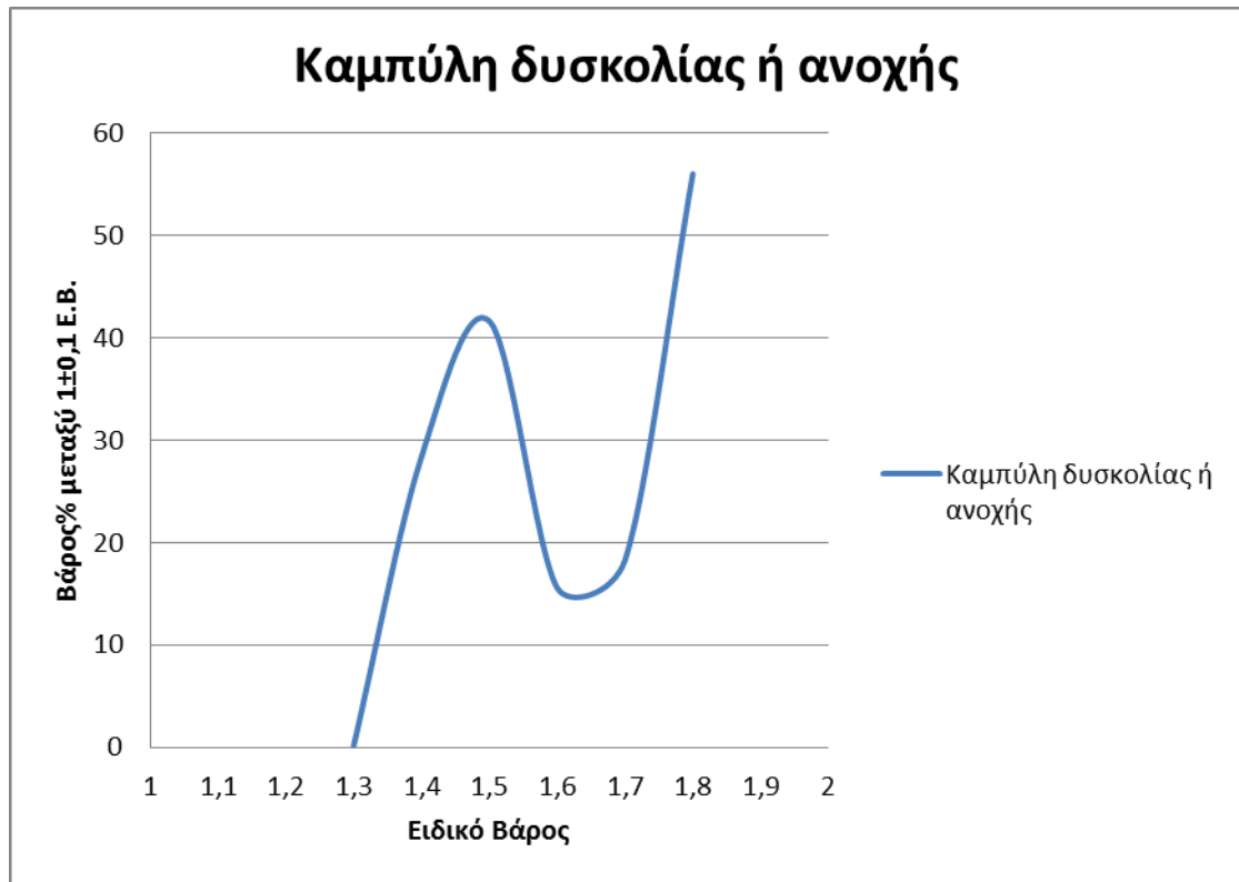
Σχήμα 26. Καμπύλη ανοχής ή δυσκολίας διαχωρισμού για το κοκκομετρικό κλάσμα -6,68 +2,35 mm
