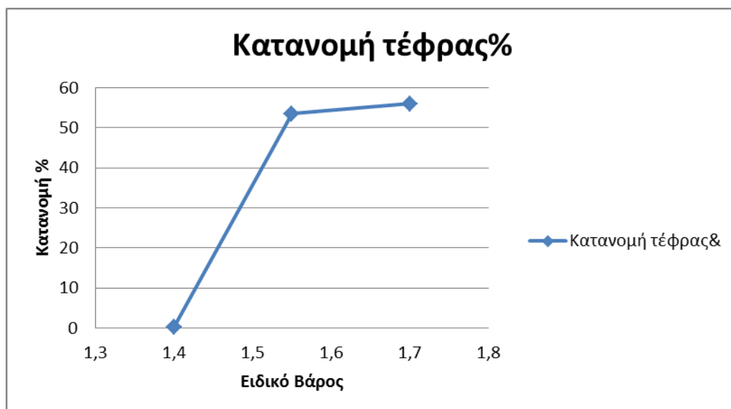
Σχήμα 20. Κατανομή τέφρας % κοκκομετρικό κλάσμα -10+6,68 mm
