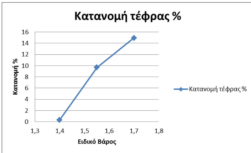
Σχήμα 30. Κατανομή τέφρας για το ελαφρύ για το κοκκομετρικό κλάσμα -2,35 mm
