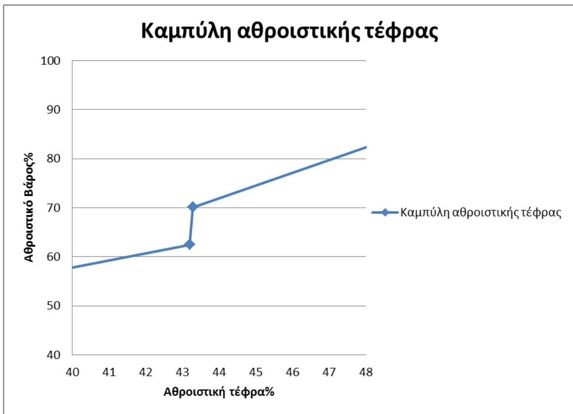
Σχήμα 8. Καμπύλη αθροιστικής τέφρας για το κοκκομετρικό κλάσμα +20mm
