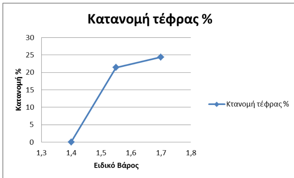
Σχήμα 25. Κατανομή τέφρας στο ελαφρύ σε συνάρτηση με το ε.β. για το κοκκομετρικό κλάσμα -6,68+2,35 mm
