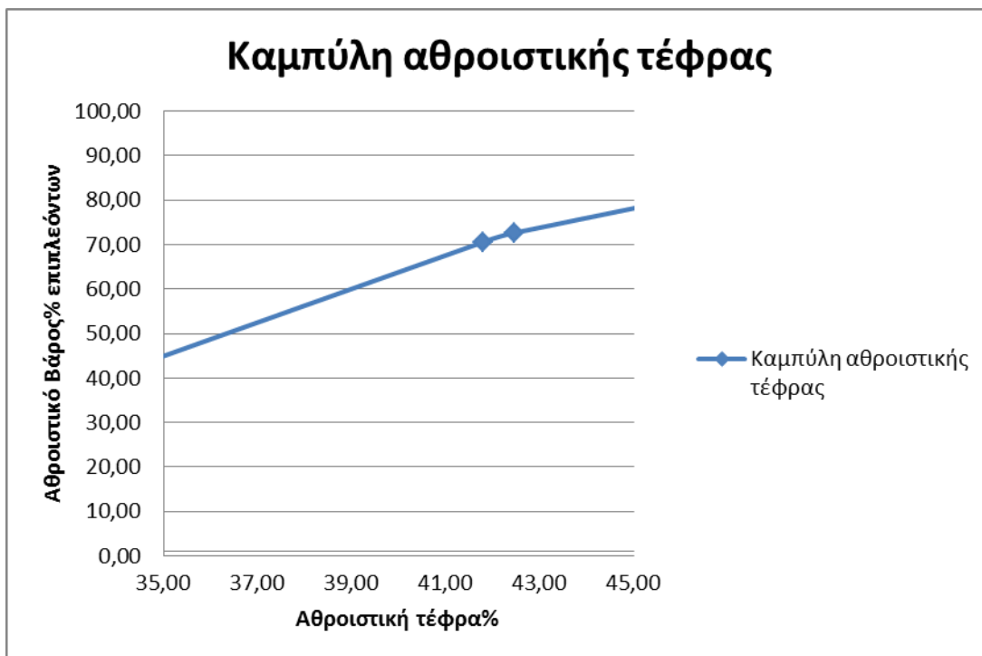
Σχήμα 18 .Καμπύλη αθροιστικής τέφρας για το κοκκομετρικό κλάσμα-10+6,68mm
