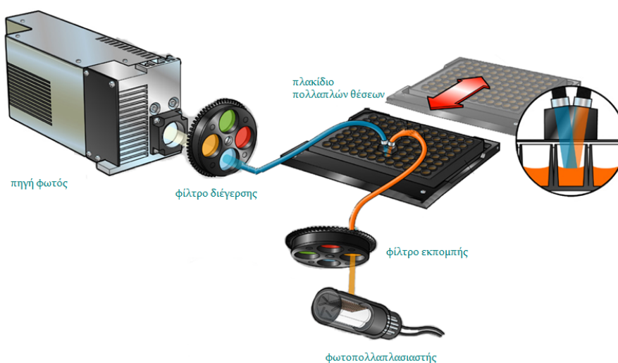
Σχήμα 6.4: Φασματοφωτομετρική διάταξη πολλαπλών λειτουργιών για πλακίδιο πολλαπλών κυψελίδων. Απλοποιημένη γραφική αναπαράσταση
