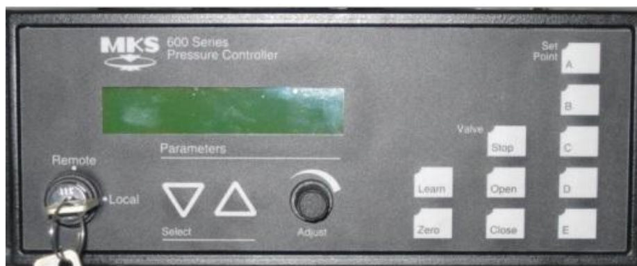
Εικόνα 5.2: Ηλεκτρονικό μανόμετρο καθορισμού και μέτρησης της πίεσης εντός του αντιδραστήρα.
