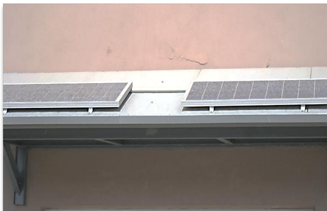
Εικόνα 3.3.6: Τα δύο πλαίσια μετά από τη πρώτη βροχή. Το αριστερό πλαίσιο είναι το υπ' αριθμόν 1 και το δεξιό το υπ' αριθμόν 2. Το πλαίσιο 2 είναι αυτό που η επιφάνειά έχει επικαλυθεί με την επίστρωση.
