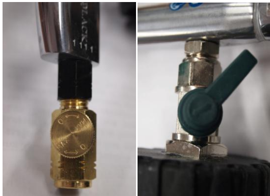
Εικόνα 1.9.9: (α) Ρυθμιστής παροχής αέρα του ψεκαστικού (β) Ρυθμιστής παροχής ποσότητας του υγρού προϊόντος
