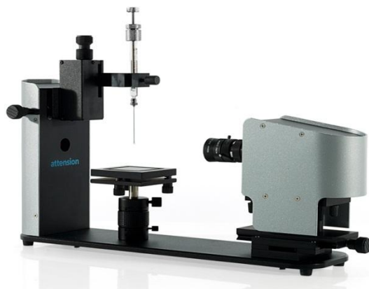
Εικόνα 2.1.3: Όργανο με το οποίο εξετάζεται η υδροφιλικότητα της επιφάνειας.
