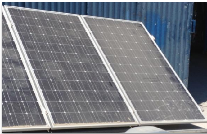
Εικόνα 1.9.10: Σύγκριση επιφάνειας φ/β πάνελ ύστερα από έκθεση σε φυσικό περιβάλλον για 6 μήνες (περιοχή Κύπρος). Το αριστερό πάνελ έχει επιστρωθεί με SurfaShield G.
