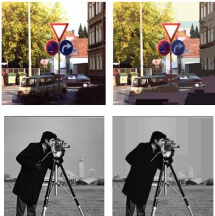
Εικόνα 14: Παράδειγμα κατάτμησης εικόνας με region growing
