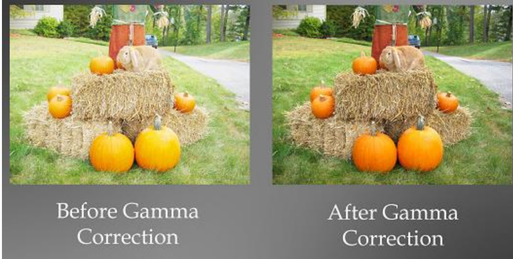
Εικόνα 2: Επεξεργασία εικόνας με χρήση συνάρτησης \gamma
