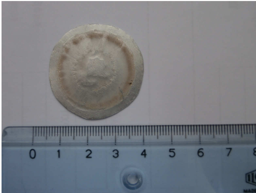
Σχήμα 5-5 Δίσκος συλλογής από Al, με δακτυλιοειδή γεωμετρία δείγματος
