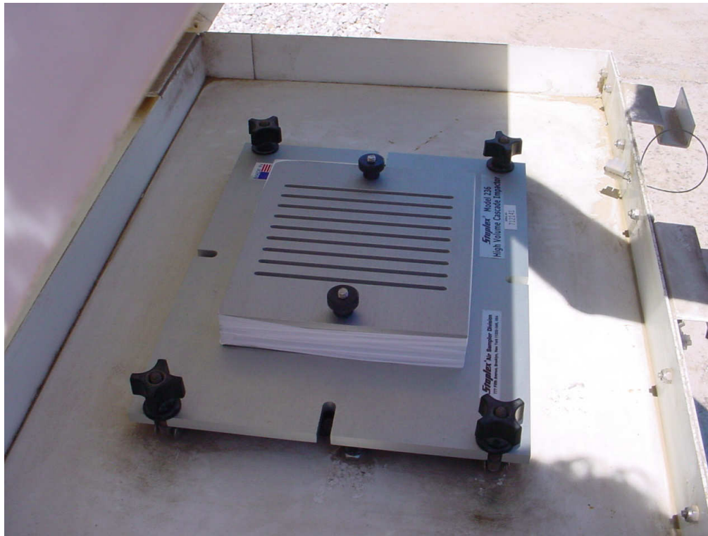
Σχήμα 4-13 Ο ΑΣΛΣ προσαρμοσμένος στην αντλία DH-50810E της F&J του ΕΠΤ-ΕΜΠ. Τα στάδια είναι τυλιγμένα με ταινία τεφλόν προκειμένου να αποφευχθεί αναρρόφηση αέρα από τα πλάγια.
