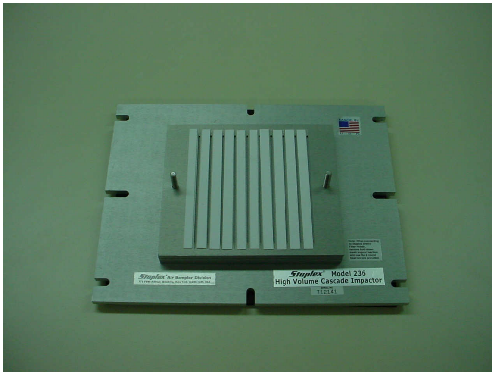
Σχήμα 4-9 Τοποθέτηση λωρίδων glass fiber στα επιμέρους στάδια του ΑΣΔΣ
