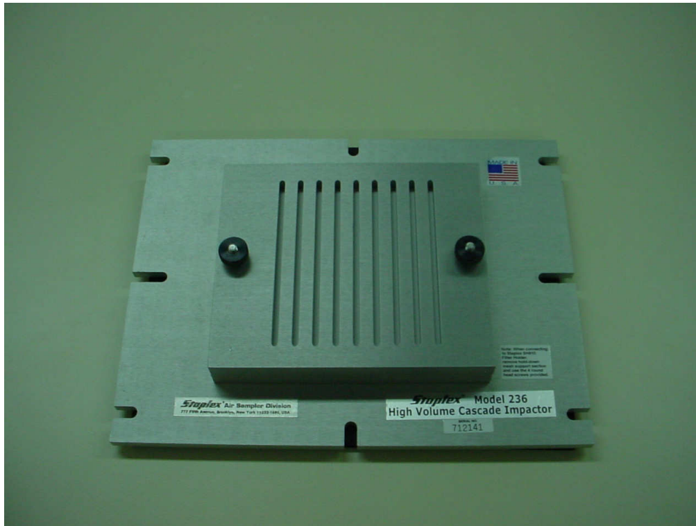
Σχήμα 4-11 Ο ΑΣΔΣ συναρμολογημένος (από τις σχισμές του 1ου σταδίου διακρίνεται φίλτρο)
