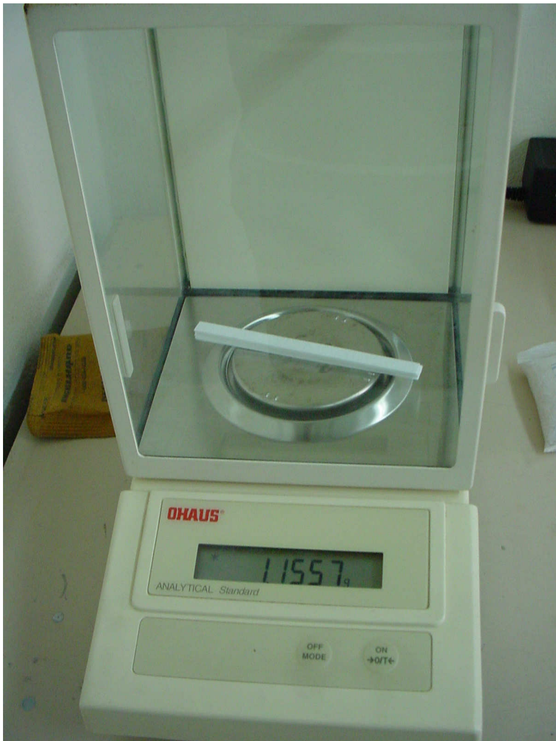
Σχήμα 4-8 Ζύγιση ανά δεκάδα των λωρίδων glass fiber στο ζυγό ακριβείας του ΕΠΤ-ΕΜΠ
