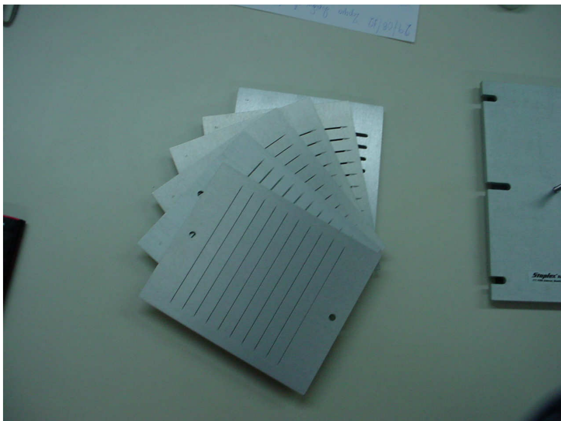
Σχήμα 4-2 Τα έξι στάδια διαχωρισμού του αεροζόλ του ΑΣΔΣ της Staplex
