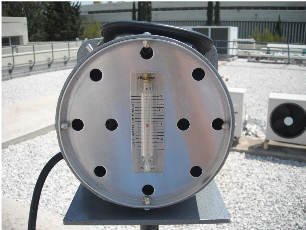
Σχήμα 5-9 ΔΑΣ του ΕΠΤ-ΕΜΠ, καπάκι, δίσκος συλλογής και δίσκος σύσφιξης
