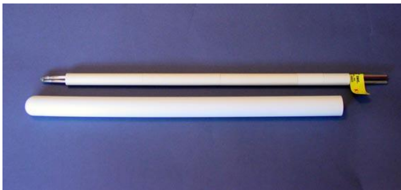
Σχήμα 4.6. Τα θερμοστοιχεία της καμίνου και το προστατευτικό κέλυφος από mullite (υλικό επένδυσης).
