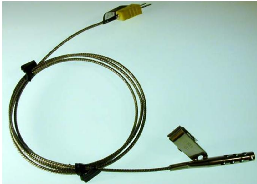
Σχήμα 5.19. Θερμοστοιχείο με διάτρητη ασπίδα ακτινοβολίας για την εξασφάλιση της ικανοποιητικής επαφής του αέρα με τον αισθητήρα. Θερμοκρασιακό εύρος λειτουργίας -73\text{ }^{\circ}\text{C} < T < 315\text{ }^{\circ}\text{C} , κατασκευάστρια εταιρία: ALLQA Products.
