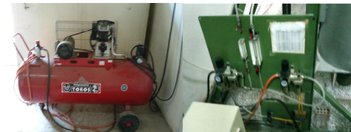
Σχήμα 4.2. Ο αεροσυμπιεστής μεγάλης δυναμικότητας (αριστερά) και το σύστημα ροόμετρων-μανομέτρων για τη ρύθμιση της ογκομετρικής παροχής του αέρα στο θάλαμο διόγκωσης.
