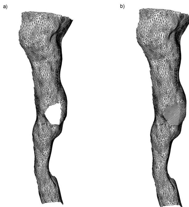
**Σχήμα 3.9: (a) Το αριστερό σκέλος της διακλάδωσης με το άνοιγμα. (b) Το ίδιο σκέλος με το άνοιγμα συμπληρωμένο από τρίγωνα.**
