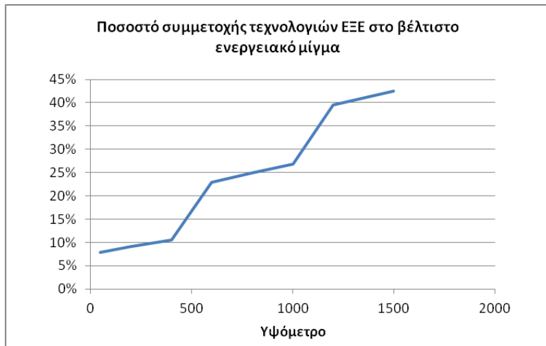
Διάγραμμα 8.14. Ποσοστιαία συμμετοχή τεχνολογιών ΕΞΕ στο συνολικό βέλτιστο ενεργειακό μίγμα (θερμότητα και ηλεκτρισμός), συναρτήσεως του υψομέτρου, για την περίπτωση του σεναρίου 2
