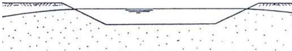
Σχήμα 5.12: Η σκαμμένη λεκάνη κατάκλυσης (Huisman και Olsthoorn, 1983)
