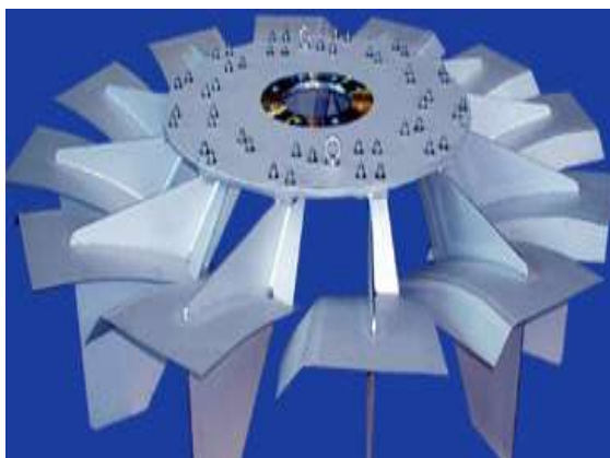
Φωτογραφία 3.3: Ο περιστρεφόμενος πλωτός αεριστήρας
