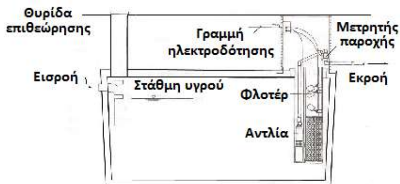
Σχήμα 3.29: Η σηπτική δεξαμενή με μηχανικό φίλτρο από διάτρητους σωλήνες (Καραμούζης, 2006)
