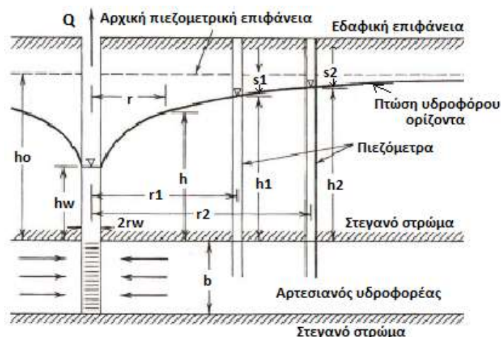
Σχήμα 5.1: Ακτινωτή ροή κατά την άντληση γεώτρησης σε αρτεσιανό υδροφόρο σύστημα (Todd και Mays, 2005)
