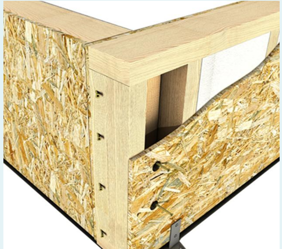
εικόνα 27: Ένωση τοιχοπετασμάτων (Κοφινά Ευγενία)
