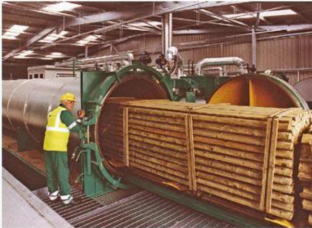
εικόνα 7: Εμποτισμός ξύλου σε κλίβανο (Πηγή: www.bg.all.biz )
