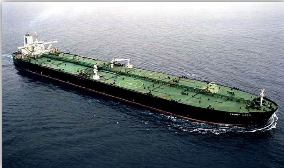
Εικόνα 10 : “ Front Lord ” (1991) , L_{OA} = 322,00 m , Deadweight : 282.057 tons (VLCC)
