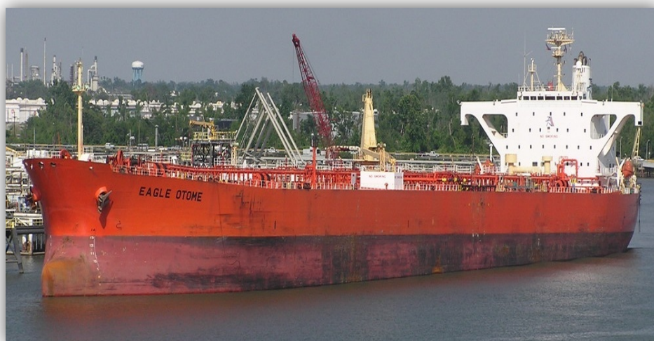
Εικόνα 8 : "Eagle Otome" (1994) , L_{OA} = 246,87 m , Deadweight : 95.663 tons (Aframax)
