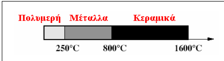
Σχήμα 1.3 Θερμοκρασιακά όρια χρήσης των υλικών
