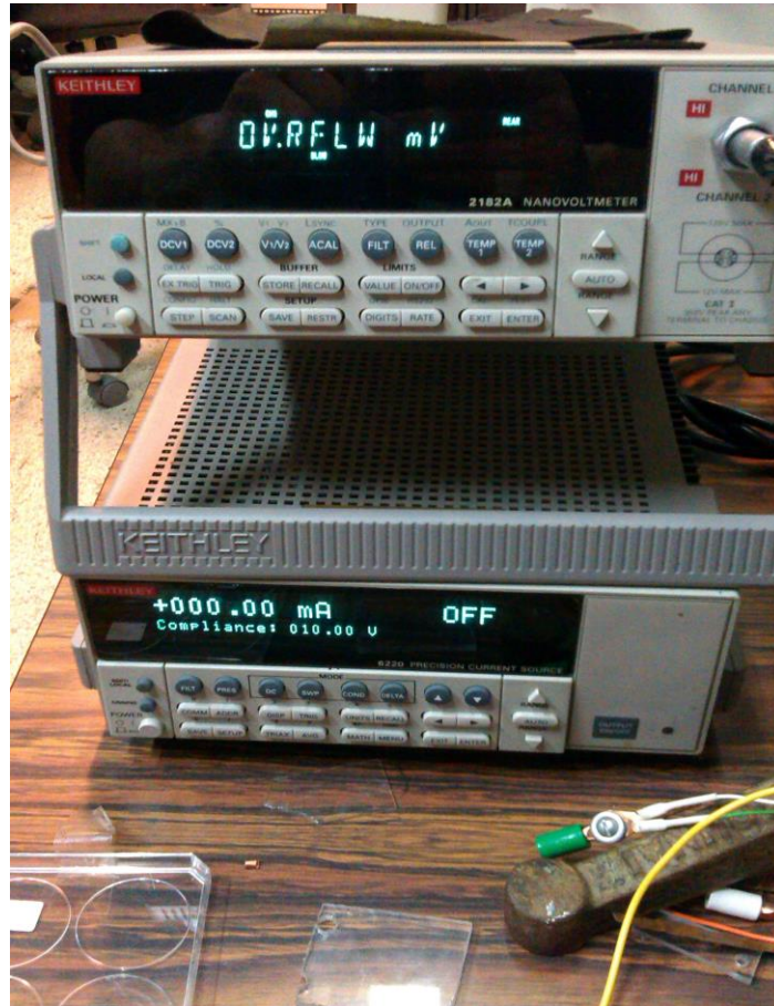
Εικόνα 4.5 Πάνω βλέπουμε το νανοβολόμετρο 2184 A Keithley ενώ κάτω τη πηγή ρεύματος 6220 Precision Current Source Keithley
