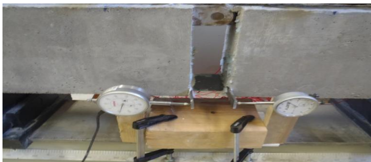
Σχήμα 3.17 Το δοκίμιο στη μηχανή κάμψης
