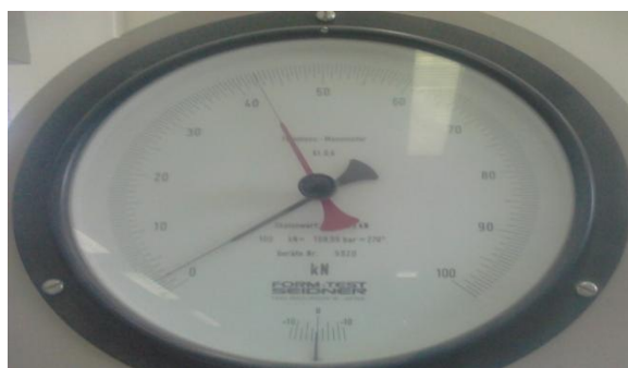
Σχήμα 3.9 Σύστημα ανάγνωσης επιβαλλόμενου φορτίου
