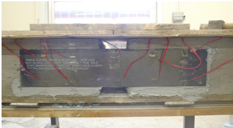
Σχήμα 3.10 Τα μηχανσιόμετρα επικολλημένα στο έλασμα
