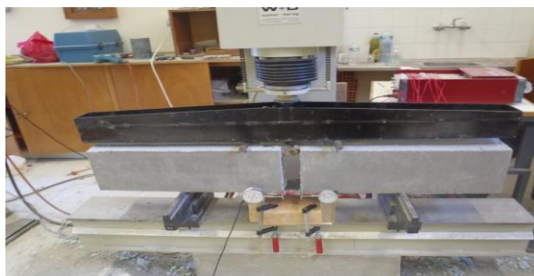
Σχήμα 3.8 Το δοκίμιο στη μηχανή κάμψης
