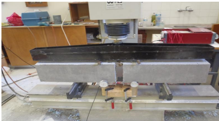
Σχήμα 3.13 Η δοκός-δοκίμιο στη μηχανή κάμψης
