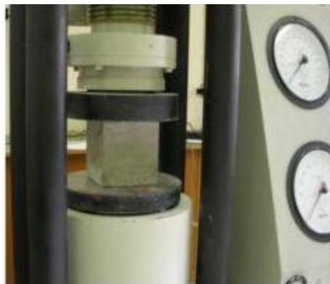
Σχήμα 3.7 Δοκιμή θλίψης κυβικού δοκιμίου
