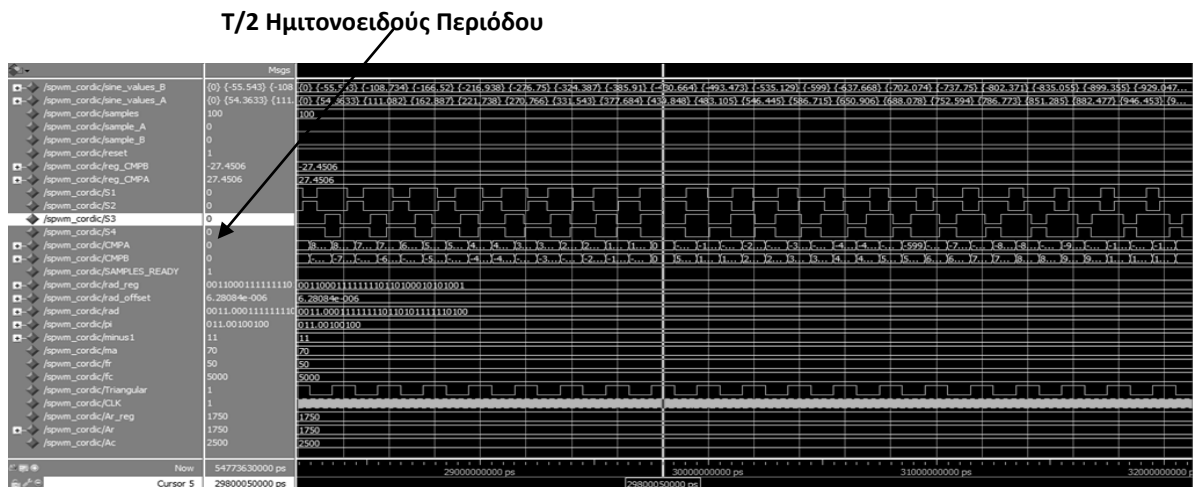
Σχήμα 3.29: Παλμοί διακοπών για το T/2 της ημιτονοειδούς περιόδου με το εργαλείο προσομοίωσης Modelsim
