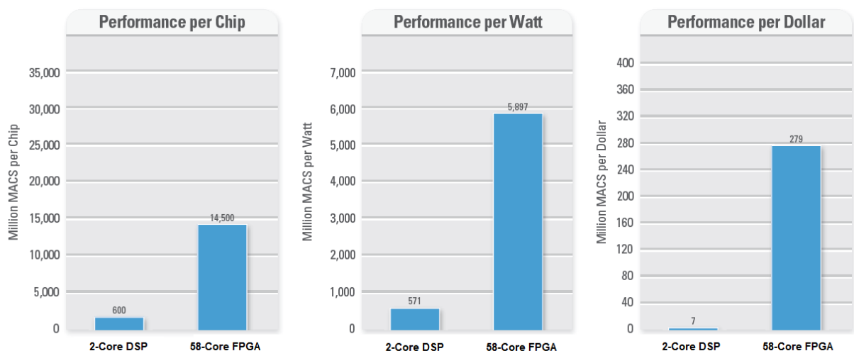
Σχήμα 1.8: Σύγκριση αποδόσεων του Spartan 6 FPGA με ένα διπύρνηνο επεξεργαστή
