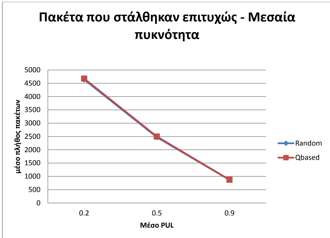
Σχήμα 4-13 - Μέσο πλήθος πακέτων που στάλθηκαν με επιτυχία για πράκτορες SARL με τυχαία εξερεύνηση και εξερεύνηση βασιζόμενη στις τιμές Q, για κανάλια με PUL=0.2,0.5 και 0.9 και έξι δευτερεύοντες χρήστες.
