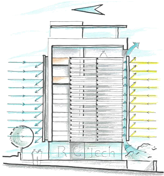
35_ Διαγραμματική περιγραφή της λειτουργίας των κατασκευών αλουμινίου.
