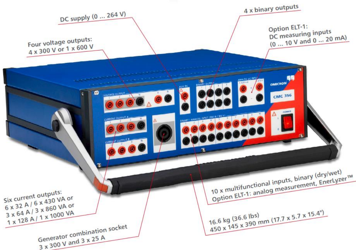
Εικόνα 4.1: Πρόψη της συσκευής δευτερογενούς ελέγχου Η/Ν προστασίας CMC 356 μαζί με τις βασικότερες δυνατότητες/προδιαγραφές της [41]
