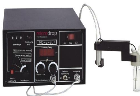
Εικόνα 2.1: Κύριο μέρος του μικροδοσομετρητή και ηλεκτρονικά οδήγησης
