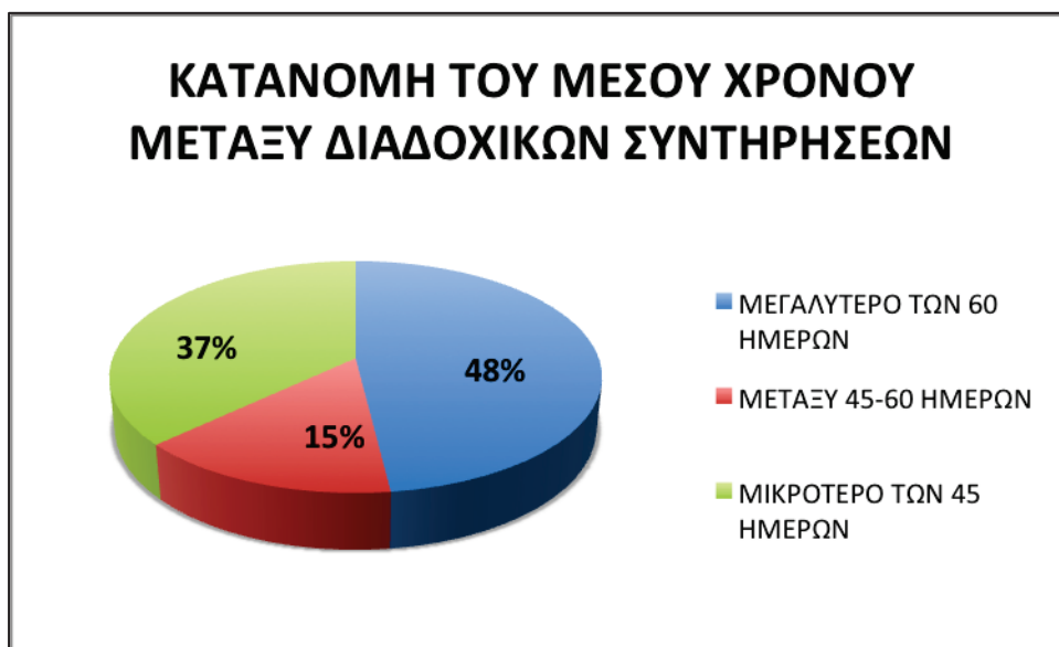
Σχήμα 7.2: Γράφημα που αναπαριστά την κατανομή του μέσου χρόνου μεταξύ διαδοχικών συντηρήσεων του δείγματος των 27 οχημάτων.
