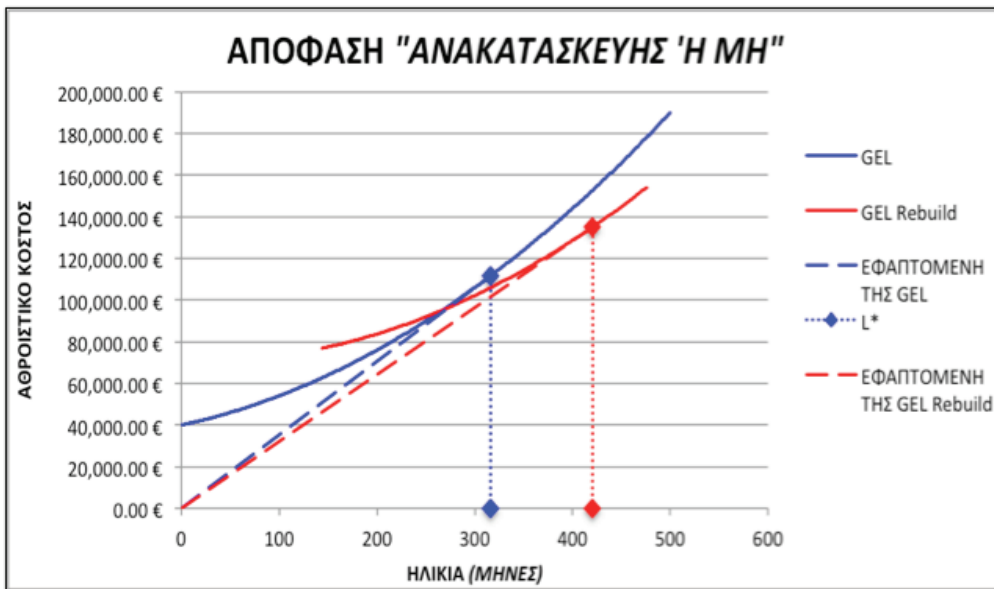
Σχήμα 6.15: Διάγραμμα στο οποίο απεικονίζεται θετική απόφαση ανακατασκευής για ηλικία ανακατασκευής 180 μήνες και πρόβλεψη ηλικίας μετά την ανακατασκευή 36 μήνες.
