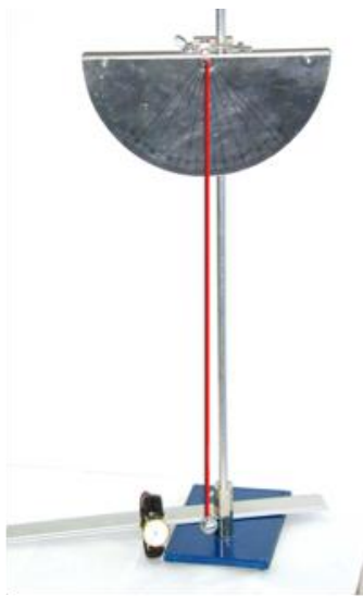
Εικόνα 2.3: Μέτρηση Βαρύτητας με Εκκρεμές (πηγή: ΕΚΦΕ ΑΝΑΤΟΛΙΚΗΣ ΑΤΤΙΚΗΣ. Υπ. Κ. Παπαμιχάλη)
