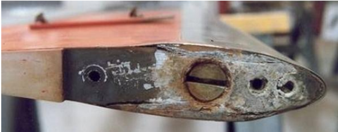
Εικόνα 3: Χαρακτηριστική μορφή εμφάνισης γαλβανικής διάβρωσης σε σημείο επαφής δυο διαφορετικών μετάλλων [5].
