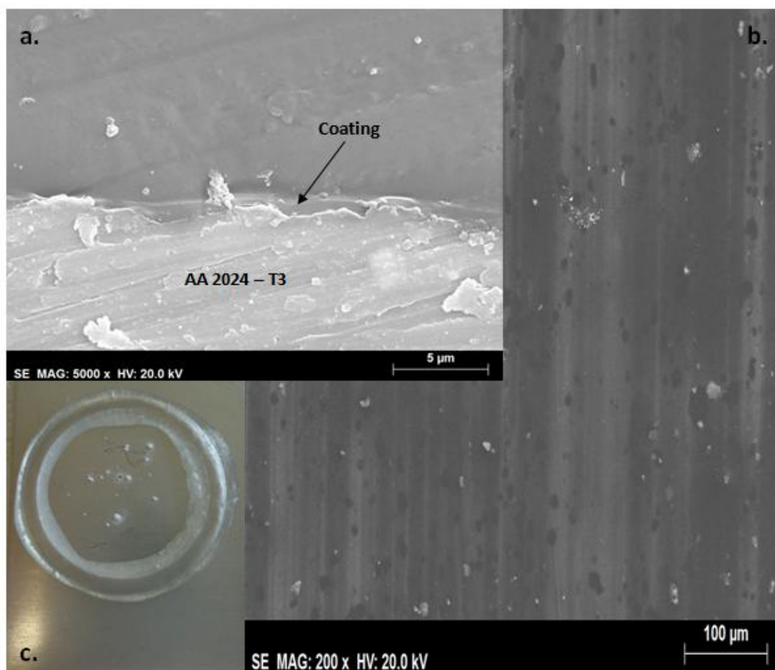
Εικόνα 47 (a, b, c): Τομή (a) και επιφάνεια της επίστρωσης ρητίνης πριν την έκθεση σε διαβρωτικό περιβάλλον (b). Εμφάνιση διάβρωσης μετά από έκθεση 720 h (30 d) (c).
