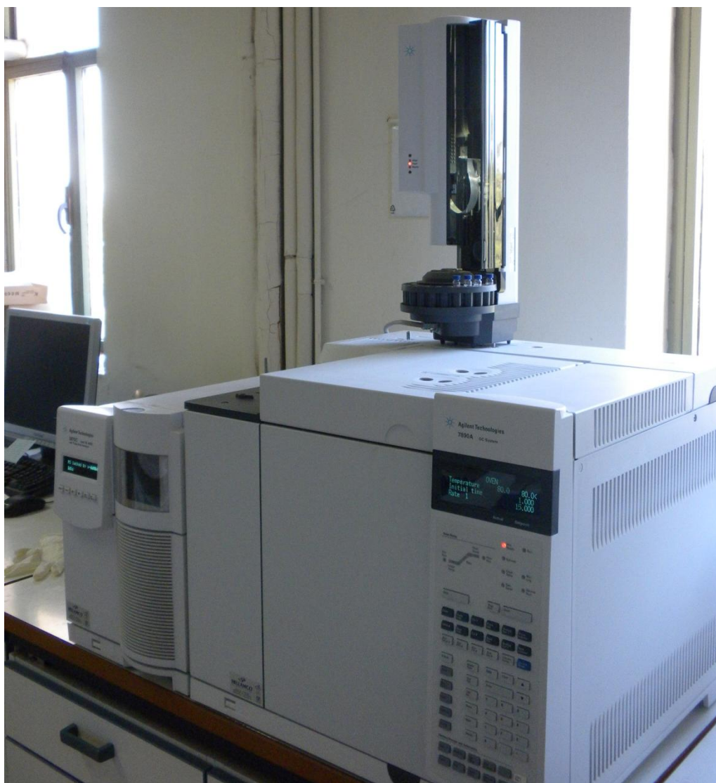
Σχήμα 4.7: Αέριος χρωματογράφος τύπου Agilent 7890A συζευγμένος με φασματογράφο μάζας Agilent 5975C
