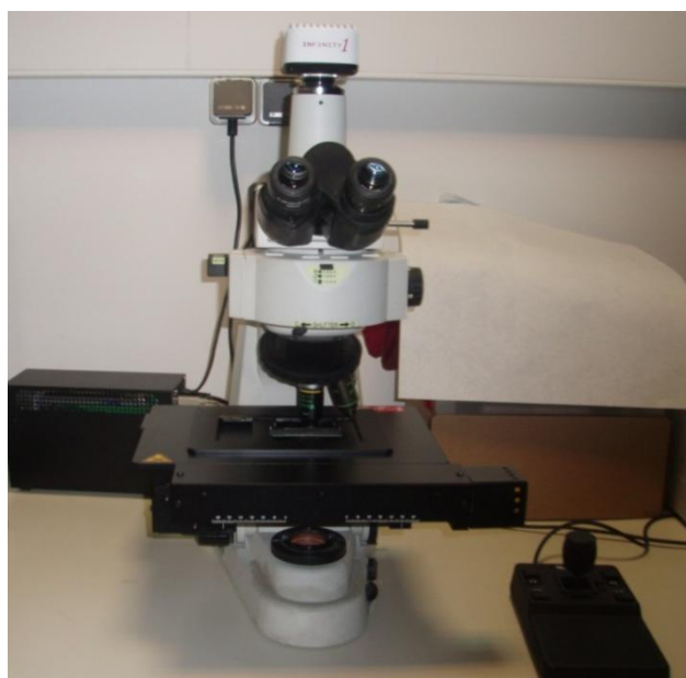
Εικόνα 3-8: Μικροσκόπιο με τεχνική αντίθεσης φάσεως με ηλεκτροκίνητη τράπεζα (άξονες x,y) και έγχρωμη ψηφιακή κάμερα μικροσκοπίας
