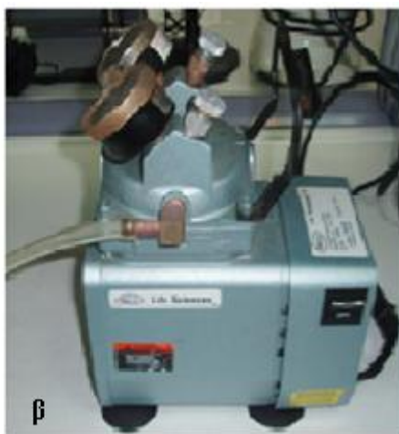
Εικόνα 3-1: α) Μονάδα διήθησης και β) αντλία κενού
