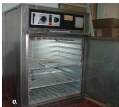
Εικόνα 3-2: α) Φούρνος στη θερμοκρασία των 103 °C και β) ξηραντήρας
