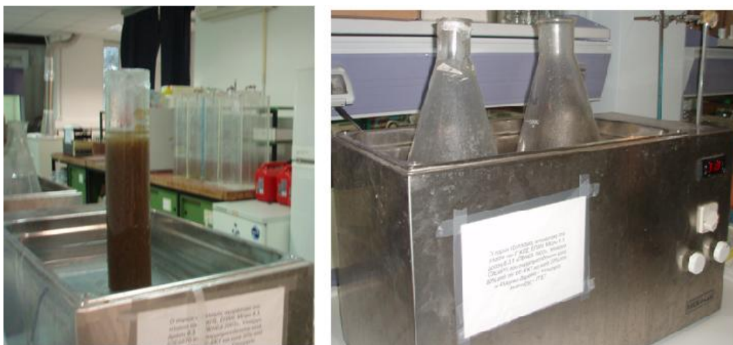
Εικόνα 3-7: Διάταξη του πειράματος διερεύνησης της επίδρασης της θερμοκρασίας στα χαρακτηριστικά καθιζησιμότητας ενεργού ιλύος
