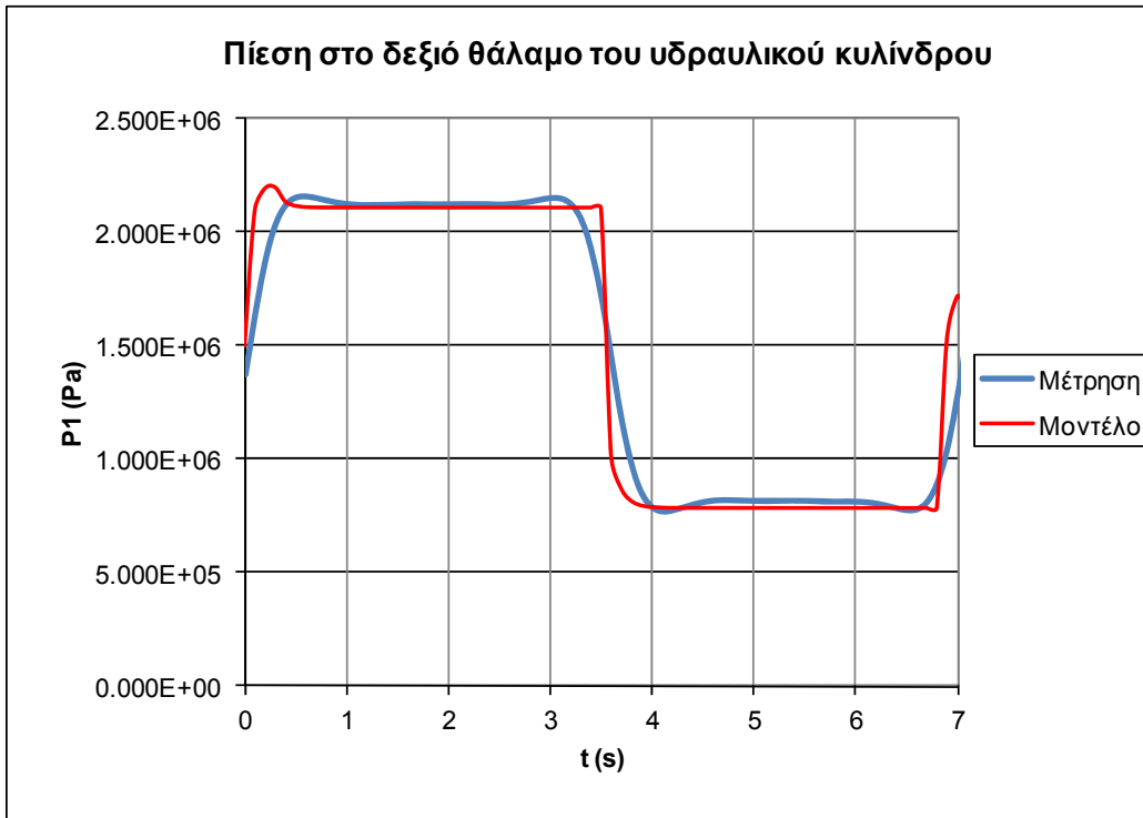
Σχήμα 6.63 Πίεση στο δεξιό θάλαμο του υδραυλικού κυλίνδρου, σύγκριση πειραματικών με θεωρητικά δεδομένα
