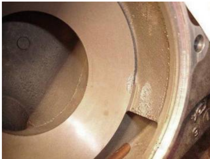
Σχήμα 9.23 Φθορά (pitting) λόγω σπηλαίωσης στο σώμα αντλίας υψηλής πίεσης
