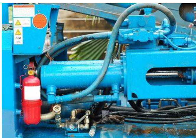
Σχήμα 9.76 Ο σωστός υπολογισμός του φορτίου και η σωστή στήριξη του υδραυλικού κύλινδρου είναι απαραίτητα για τη σωστή λειτουργία του
