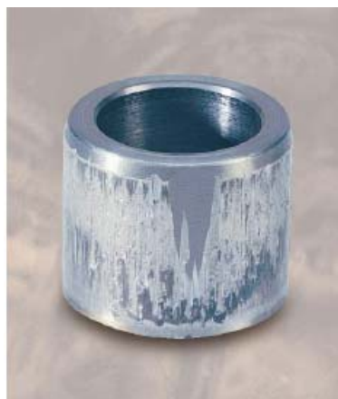
Σχήμα 2.10 Χημική διάβρωση σε ελαστικό «στοπ» υδραυλικού κυλίνδρου (φωτό:Parker)
