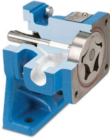
Σχήμα 9.36 Αντλία εσωτερικής οδόντωσης τύπου Gerotor.
