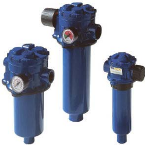
Σχήμα 9.86 Φίλτρα γραμμής επιστροφής. Το μανόμετρο μετρά την πτώση πίεσης στο φίλτρο ώστε να μπορεί να διαπιστωθεί ο βαθμός κορεσμού του
