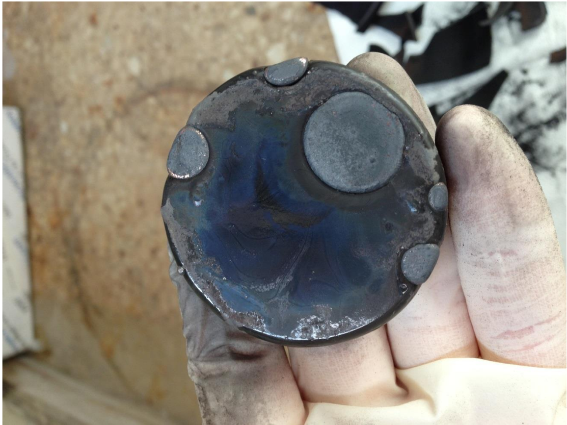
Εικόνα 3.7: Στερεοποιημένες φάσεις σκωρίας και μετάλλου στον πυθμένα του χωνευτηρίου
