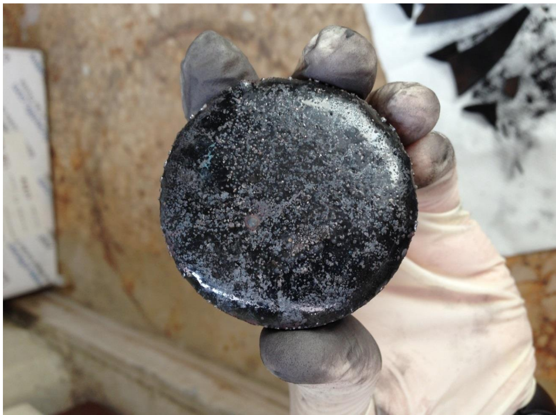
Εικόνα 3.6: Στερεοποιημένες φάσεις σκωρίας και μετάλλου στην επιφάνεια του χωνευτηρίου
