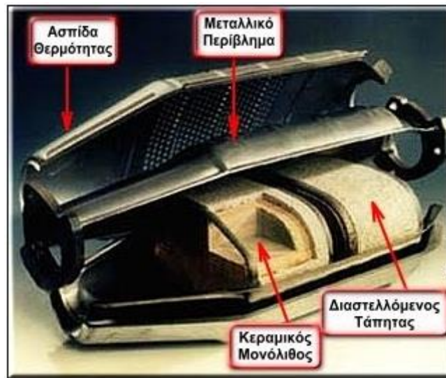
Εικόνα 2.8: Λεπτομέρεια καταλύτη περιβεβλημένου με ανθεκτικό υλικό
