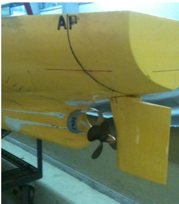
Εικόνα 11.1 Τοποθέτηση της έλικας στο μοντέλο για την διεξαγωγή των πειραμάτων αυτοπρόωσης
