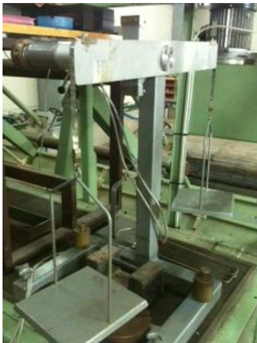
Εικόνα 7.2 Βαθμονόμηση αισθητήρα μέτρησης ροπής
