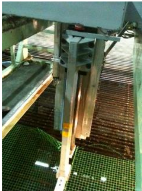
Εικόνα 2.3 Δυναμόμετρο μέτρησης της αντίστασης
