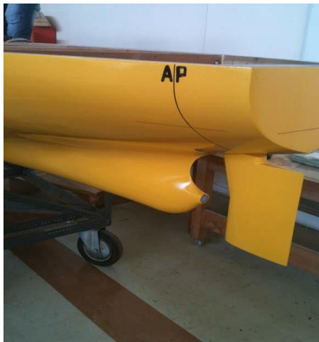
Εικόνα 6.2 Πρυμναία κάθετος και ίσαλος Full Load Condition μοντέλου
