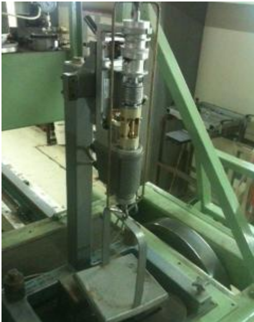
Εικόνα 7.1 Βαθμονόμηση αισθητήρα μέτρησης ώσης
