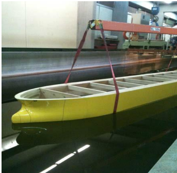
Εικόνα 6.3 Εισαγωγή μοντέλου στη δεξαμενή
