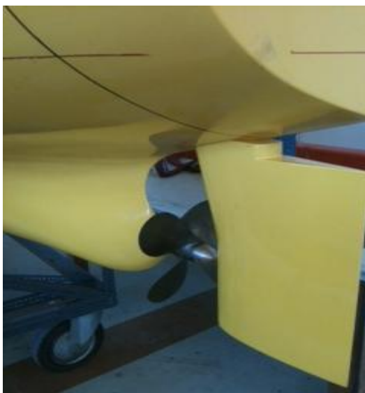
Εικόνα 7.3 Τοποθέτηση έλικας στο μοντέλο
