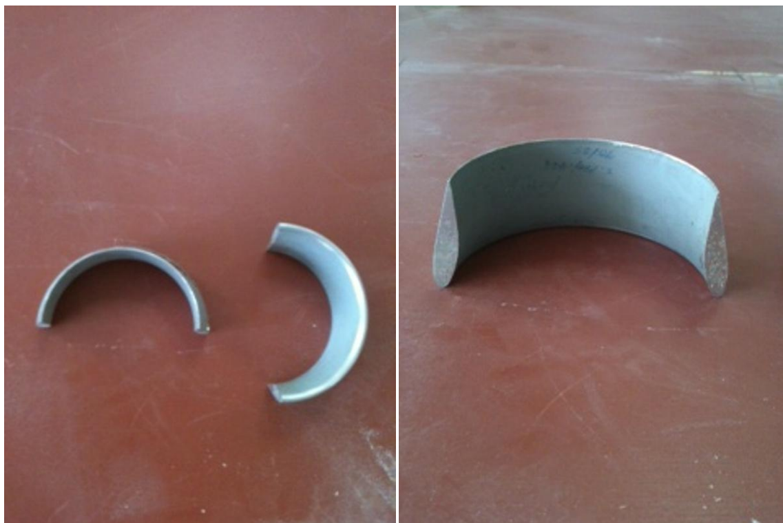
Εικόνα 9.1 Ημιδακτύλιοι τύπου WED του μοντέλου
