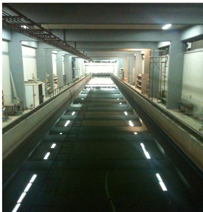
Εικόνα 2.1 Πειραματική δεξαμενή ΕΝΘΥ
