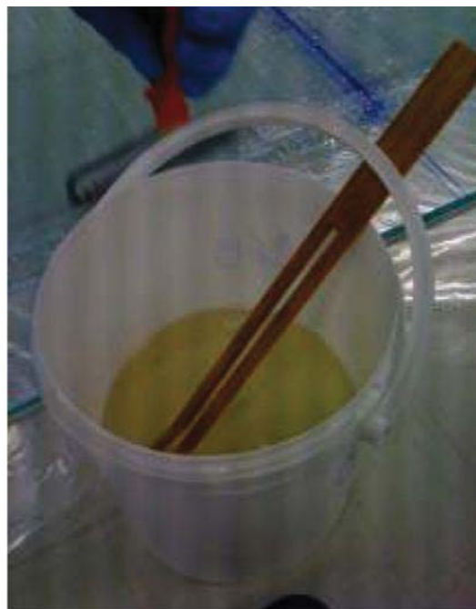
Εικόνα 3.10: Ανάμειξη ρητίνης με τον σκληρυντή
