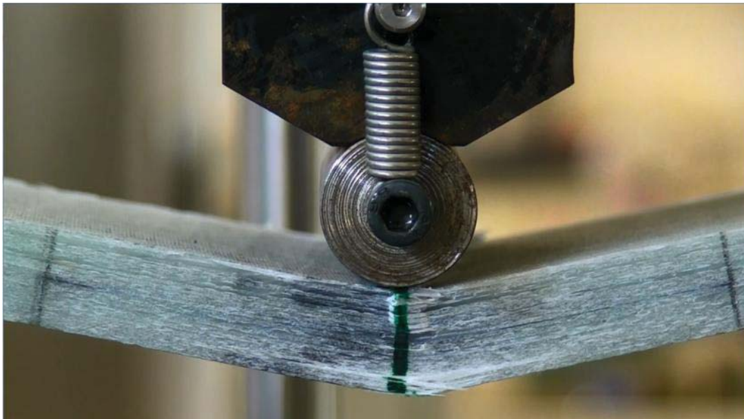
Εικόνα 4.13 : Τοπική αστοχία του δοκιμίου B_80_1
