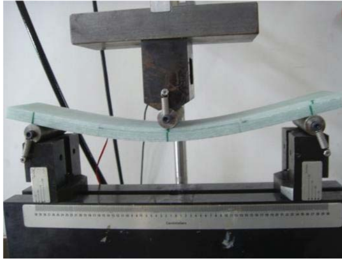
Εικόνα 4.26 : Αστοχία με διάδοση του αποχωρισμού, δοκίμιο C_140_1
