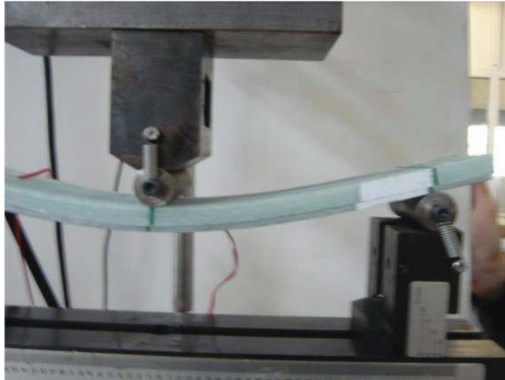
Εικόνα 4.10: Αστοχία με διάδοση του αποχωρισμού, δοκίμιο A_200_2
