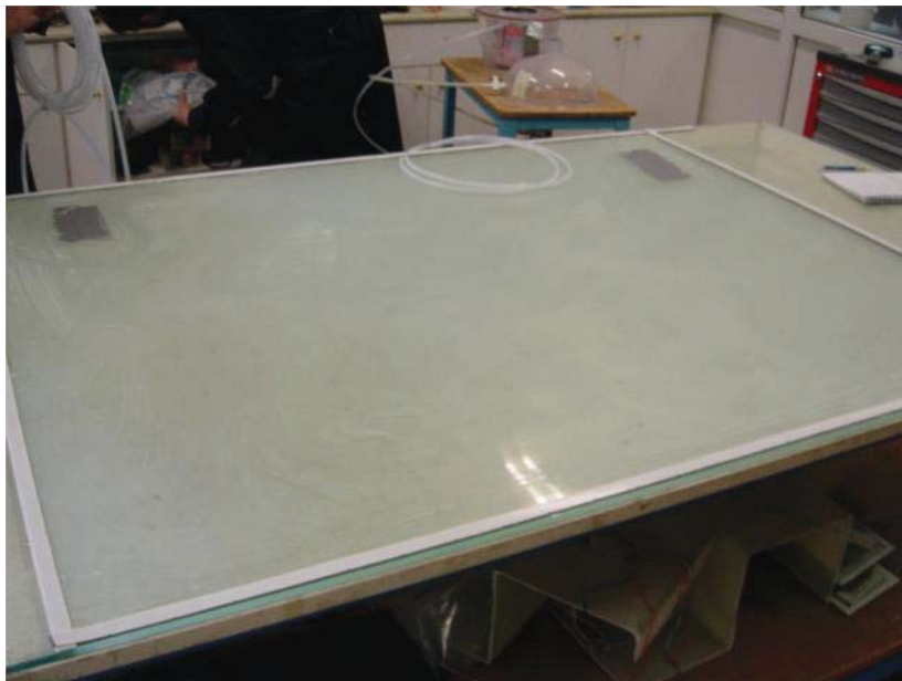
Εικόνα 3.9: Προετοιμασία και οριοθέτηση του καλουπιού
