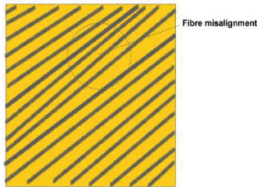
Εικόνα 1.3: Λάθος ευθυγράμμιση των ινών μιας στρώσης
