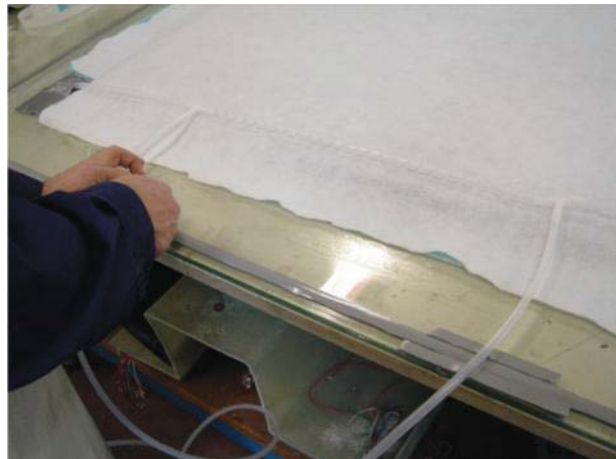
Εικόνα 3.16: Σύστημα αναρρόφησης ρητίνης
