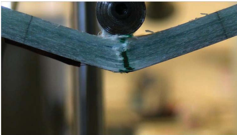
Εικόνα 4.23: Τοπική αστοχία του δοκίμιο C_80_1
