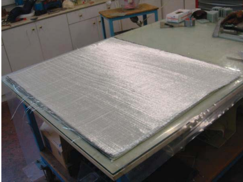
Εικόνα 3.5: Οι 20 στρώσεις των ενισχυτικών ινών της Β πλάκα
