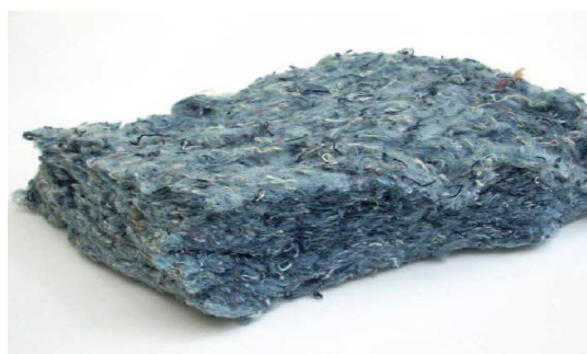
Σχήμα 8.3: Μονωτικό υλικό από ανακυκλωμένες ίνες βαμβακιού [88]
