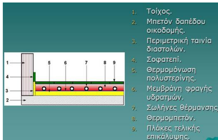
Σχήμα 7.2: Διατομή δαπέδου με σύστημα ενδοδαπέδιας θέρμανσης [87]
