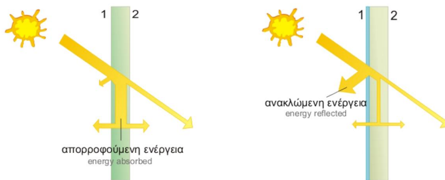
Σχήμα 10.4: Απορροφητικός (αριστερά) και ανακλαστικός (δεξιά) υαλοπίνακας [108]
