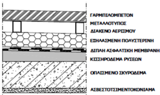
Σχήμα 6.5: Σχηματική τομή αεριζόμενου δώματος [71]
