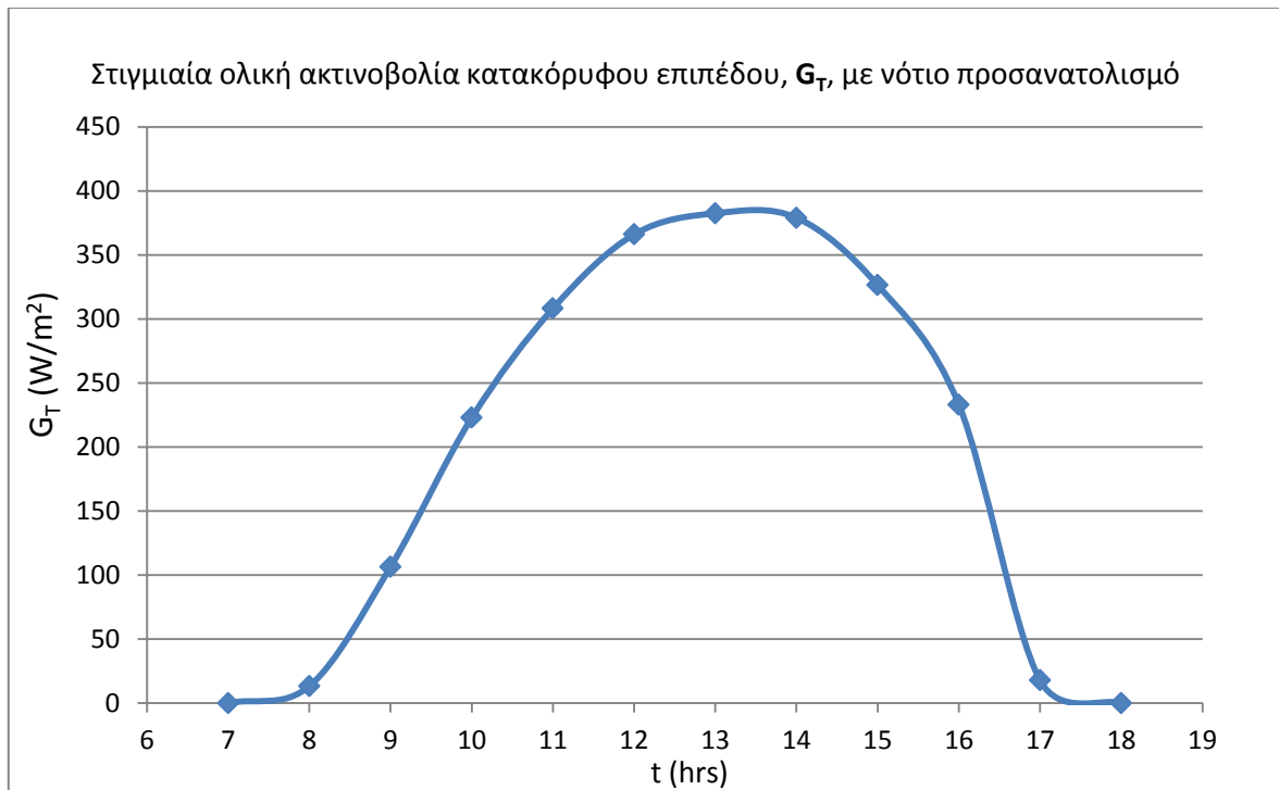
Σχήμα 14.1.1: Διακύμανση της ολικής στιγμιαίας ακτινοβολίας κατακόρυφου επιπέδου, G_T , με νότιο προσανατολισμό συναρτήσεως των ωρών κατά την 21 η Ιανουαρίου
