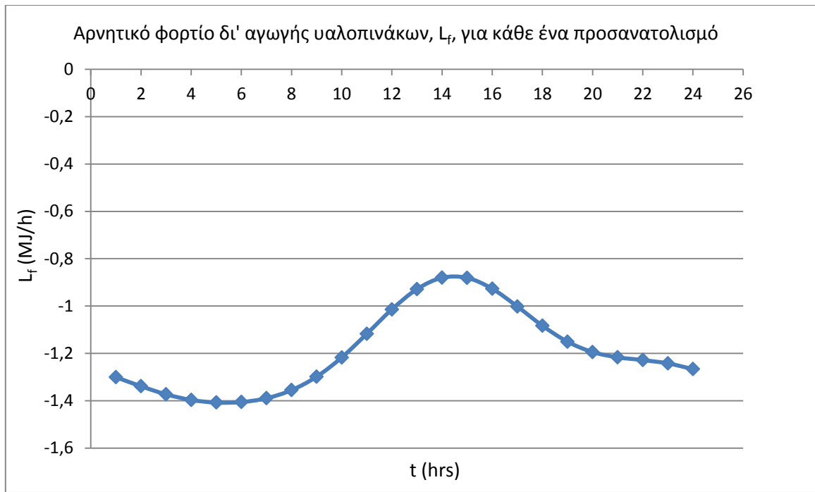
Σχήμα 14.3.1: Αρνητικό φορτίο δι' αγωγής υαλοπινάκων, L_f (MJ/h), για κάθε προσανατολισμό και για κάθε ώρα κατά την 21 η Ιανουαρίου
