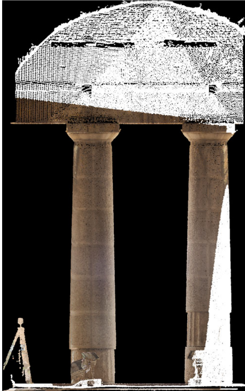
Εικόνα 3.8: Τελική ορθοφωτογραφία κίωνων. Κλίμακα 1:50, Καθορισμός επιπέδου παράλληλο με την ακμή του άβακα. Μέθοδος πλήρωσης κενών εικονοψηφίδων
