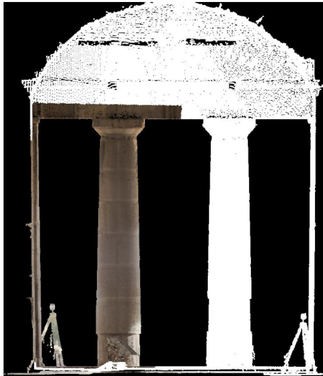
Εικόνα 2.19: Με λευκό απεικονίζονται τα σημεία του νέφους για τα οποία πραγματοποιήθηκε η ορθοαναγωγή αλλά δεν εντοπίστηκαν σημεία εντός της εικόνας
