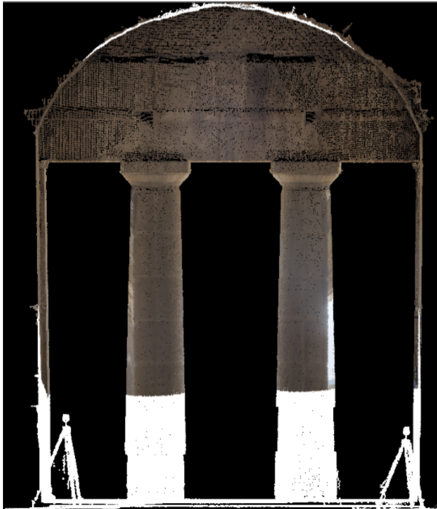
Εικόνα 3.13: Ορθοφωτογραφία άνω μέρους ανατολικής εισόδου. Χρήση γεωδαιτικώς μετρημένων φωτοσταθερών.
