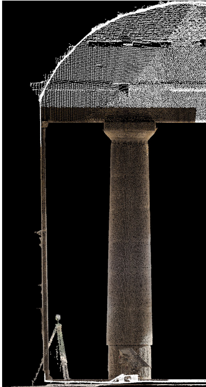
Εικόνα 3.4: Αρχική ορθοφωτογραφία αριστερού κίονα. Κλίμακα 1:50, Καθορισμός επιπέδου παράλληλο με την ακμή του άβακα. Πρόβλημα κενών εικονοψηφίδων
