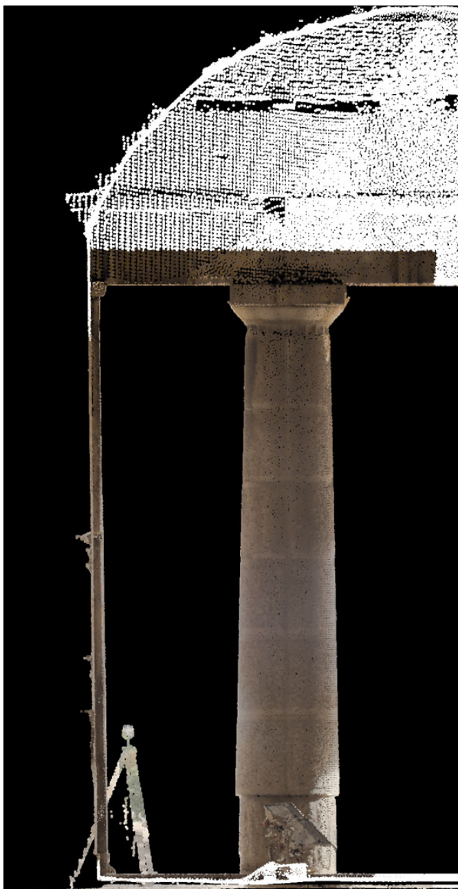
Εικόνα 3.5: Τελική ορθοφωτογραφία αριστερού κίονα. Κλίμακα 1:50, Καθορισμός επιπέδου παράλληλο με την ακμή του άβακα. Διαδικασία πλήρωσης κενών εικονοψηφίδων
