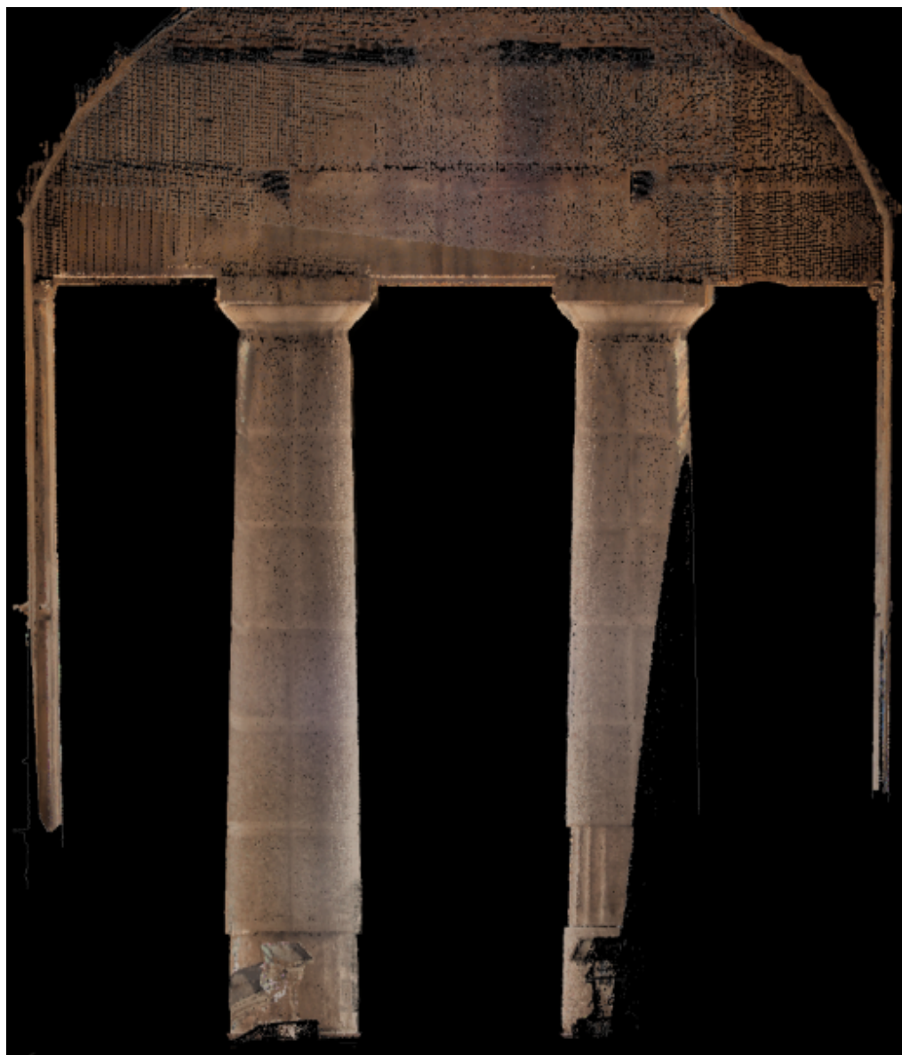
Εικόνα 3.12: Ορθοφωτομωσαϊκό της ανατολικής εισόδου
