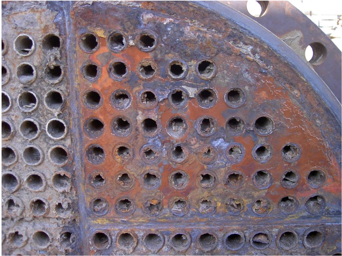
Εικόνα Β.4. Σωλήνες ενός από τους εναλλάκτες από την συσσώρευση του κωκ.
