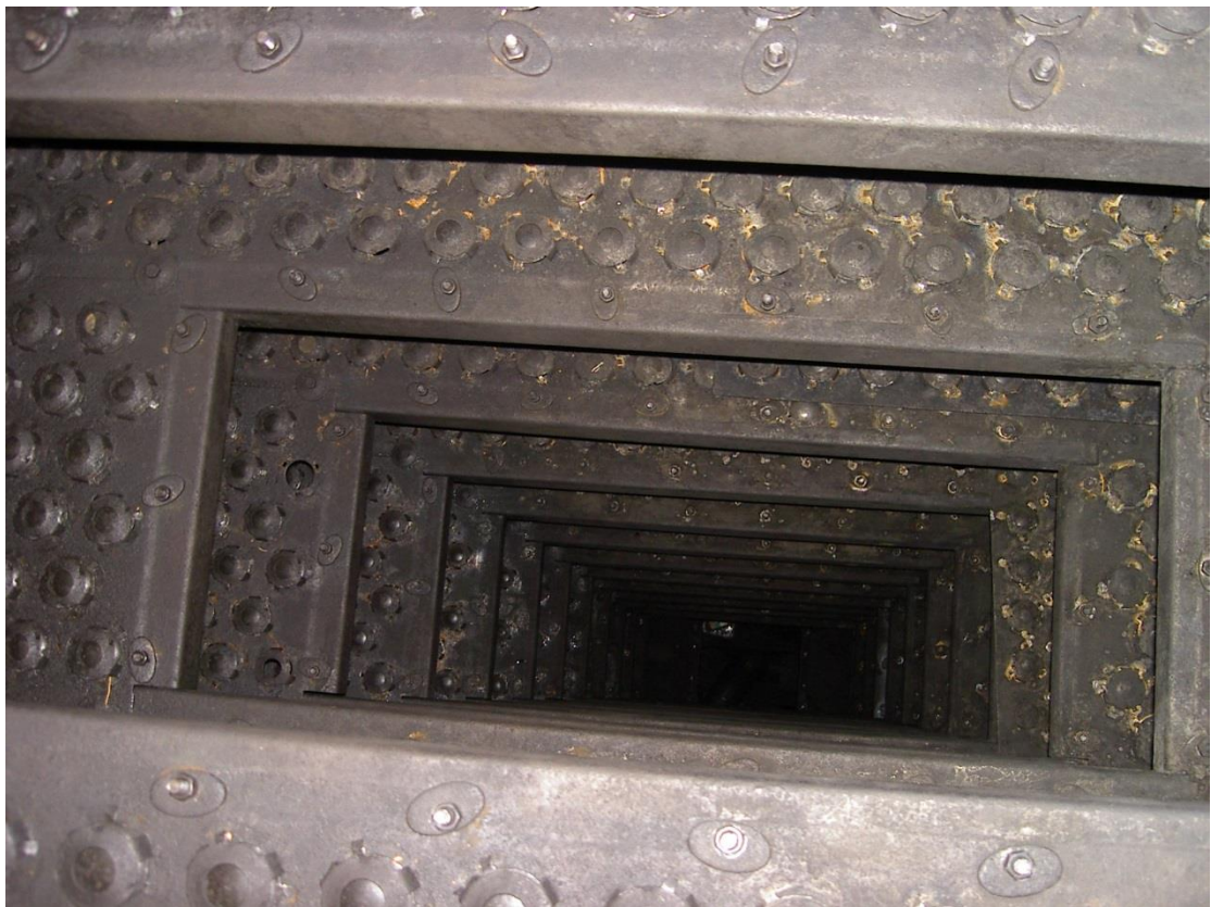
Εικόνα Β.5. Καθαρισμένη ανθρωποθυρίδα δίσκων του πύργου απόσταξης(N3901)
