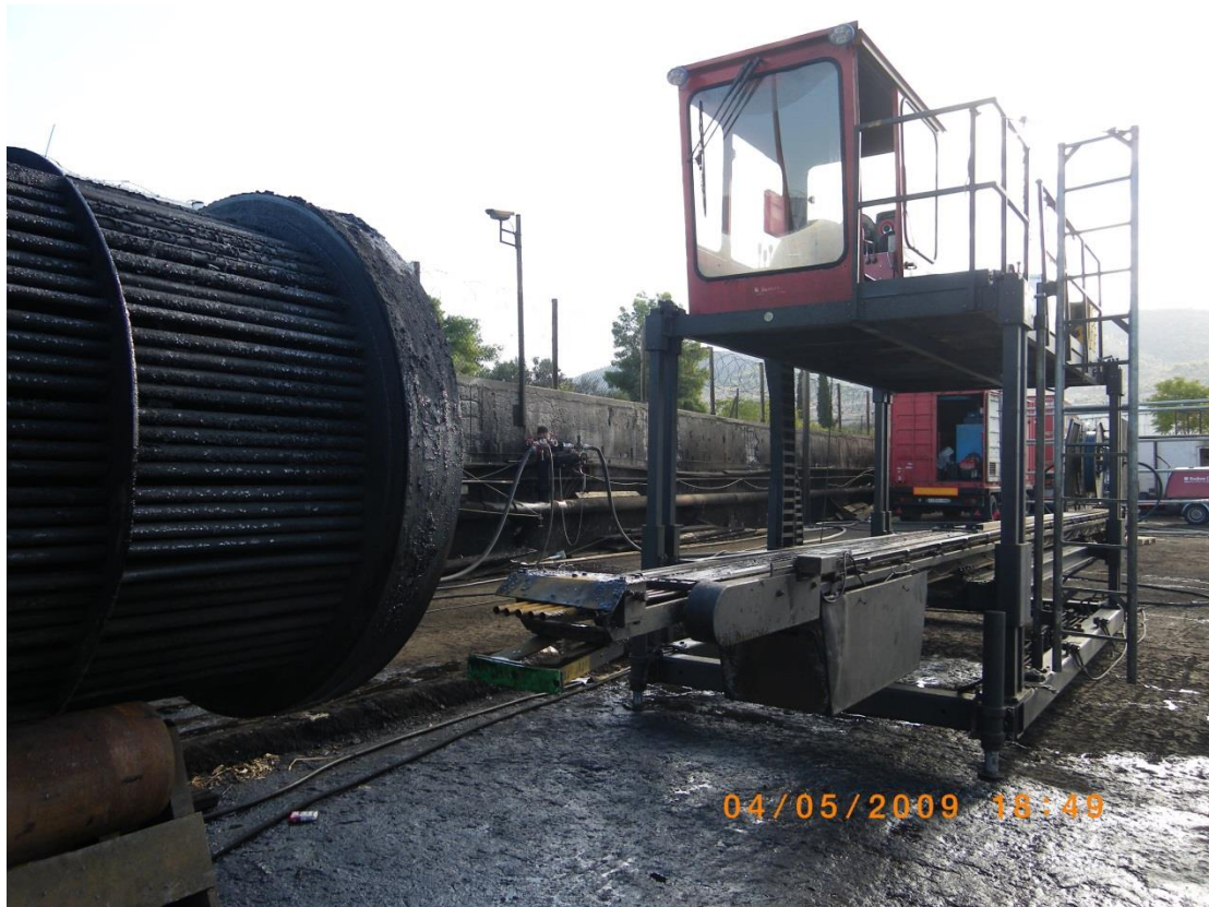
Εικόνα Β.6. "Βαγονάκι καθαρισμού" εναλλακτών από την συσσώρευση του κωκ.
