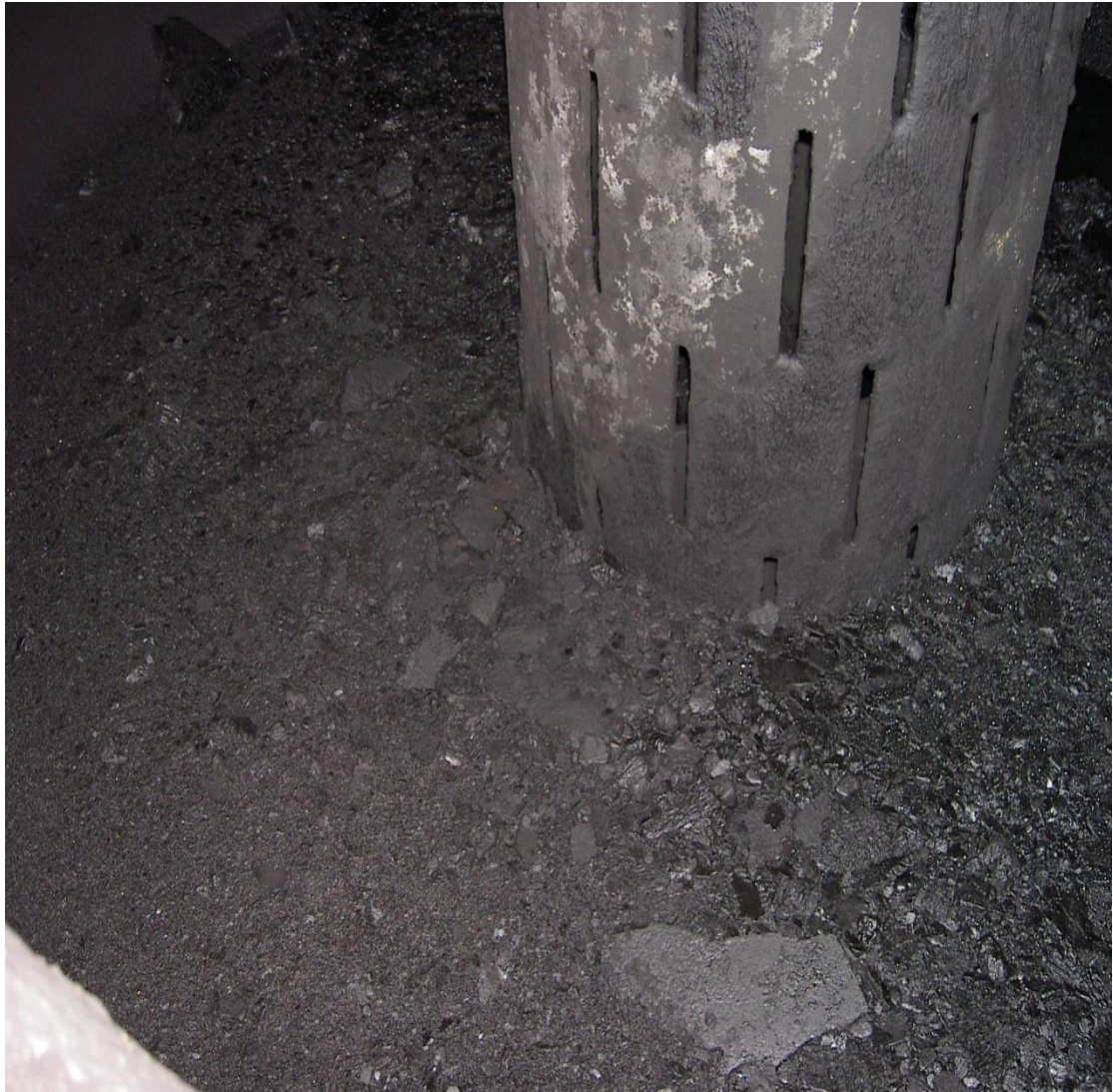
Εικόνα Β.2.Συσσώρευση κωκ στην βάση του αντιδραστήρα.
