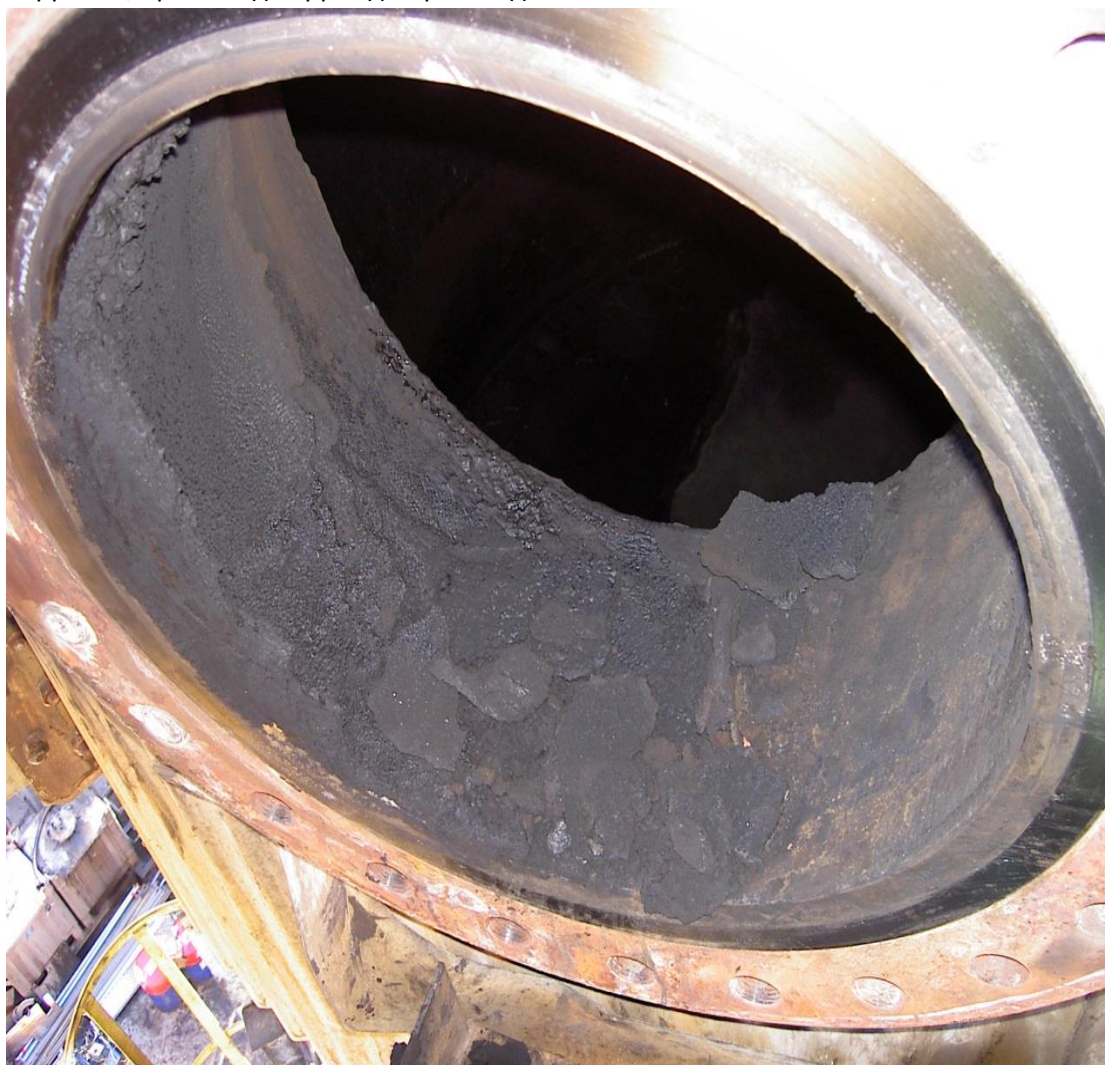
Εικόνα Β.1.Συσσώρευση κωκ στην ανθρωποθυρίδα του αντιδραστήρα της μονάδας
