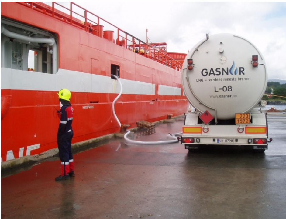
Εικόνα 15. Ανεφοδιασμός LNG από ειδικό βυτιοφόρο σε αποβάθρα
