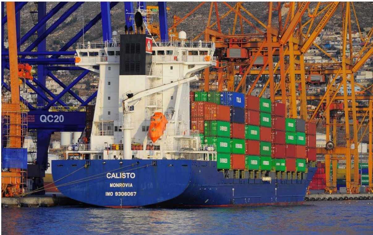
Εικόνα 21. Feeder container ship (1500 TEU) στο σταθμό διακίνησης εμπορευματοκιβωτίων στο Πειραιά (Πηγή: Marine Traffic, http://www.marinetraffic.com/ais/gr/showallphotos.aspx?imo=9306067#top_photo )
