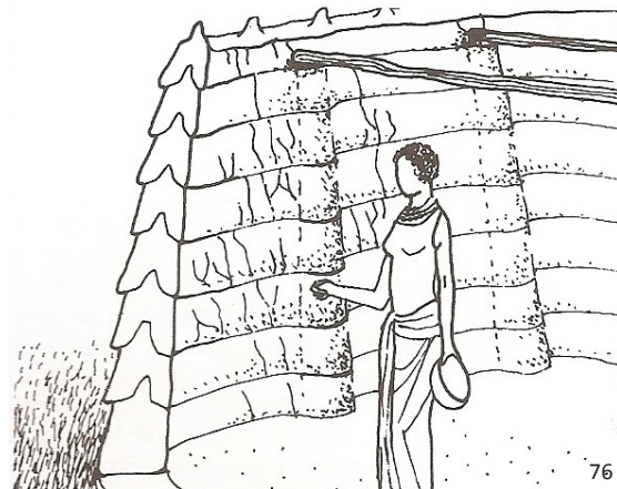
εικ.74: Κατασκευή αποθήκης με λεπτό πάχος τοίχων από πηλό (Matakam, Καμερούν) εικ.75: Κατασκευή αποθήκης σιτηρών πλάθοντας λεπτούς τοίχους με τα χέρια (Jos, Νιγηρία) εικ.76: Σκίτσο τομής σε τοίχο κατασκευασμένο από στρώσεις χώματος όπου οι ανώτερες καλύπτουν εν μέρει τη στρώση που βρίσκεται κάθε φορά από κάτω τους εικ.77: σπίτι-φρούριο στη Somba (βόρειο Μπενίν)
