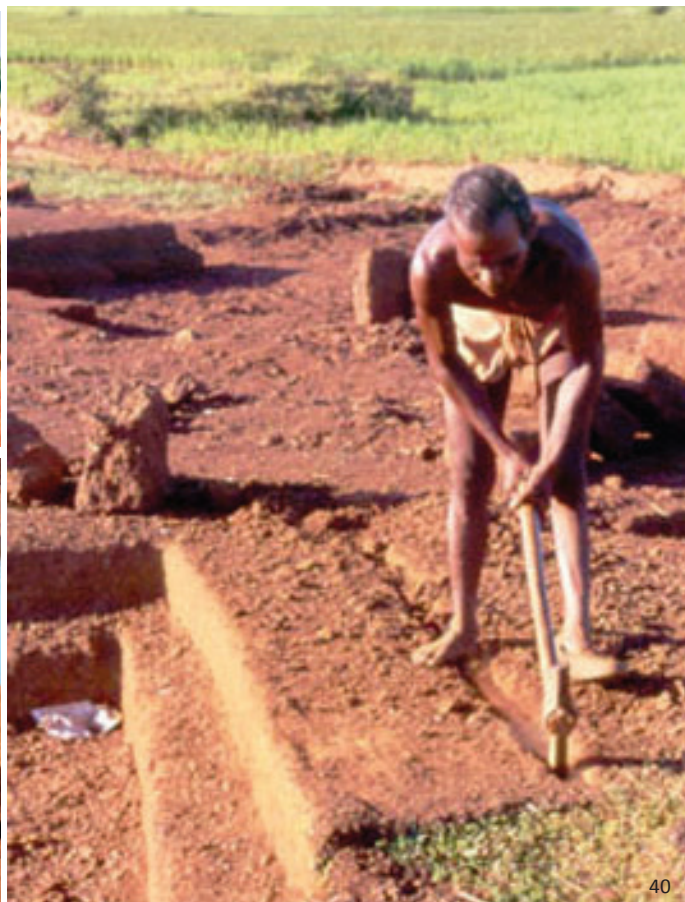
εικ.38: Λατομείο κοπής πλίνθων στη Burkina Faso εικ.39,40: Κοπή πλίνθων από φυσικά σκληρό χώμα στην Orissa της Ινδίας
