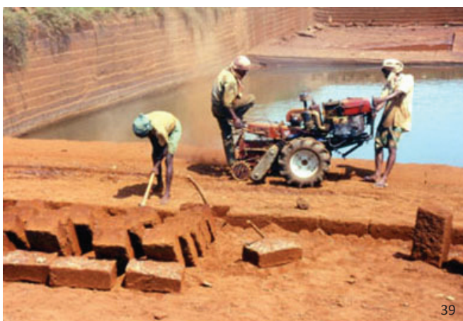
εικ.38: Λατομείο κοπής πλίνθων στη Burkina Faso εικ.39,40: Κοπή πλίνθων από φυσικά σκληρό χώμα στην Orissa της Ινδίας
