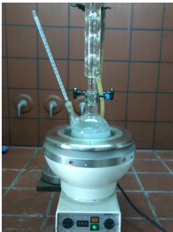
Εικόνα 6.4: Διάταξη παρασκευής άλατος 12.T
